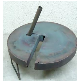
Figura 4.2. Tapa del stir casting. (Fuente: Elaboración propia)
