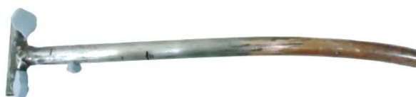
Figura 4.20. Lanza para el desgasificado del MC. (Fuente: Elaboración propia)
