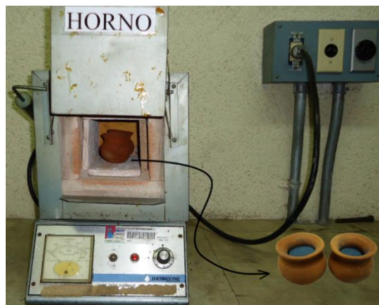
Figura 4.54. Calentamiento del polvo de SiC malla #400. (Fuente: Elaboración propia)
