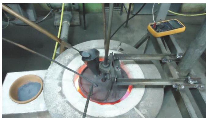
Figura 4.65. Adición del polvo de SiC malla #400 en la matriz fundida Al-Si 365.0 a través del embudo de la tapa del crisol. (Fuente: Elaboración propia)
