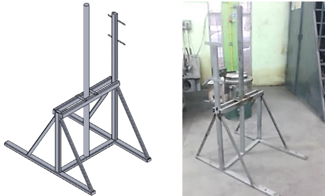
Figura 3.14. Diseño y construcción de la estructura del stir casting. (Fuente: Elaboración propia)
