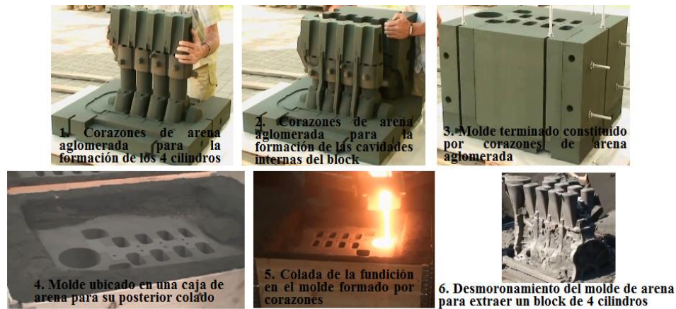
Figura 1.5. Fundición de un block de cilindros en molde desechable de arena aglomerada. (Fuente: https://www.youtube.com/watch?v=Z8MaVaqNr3U )
