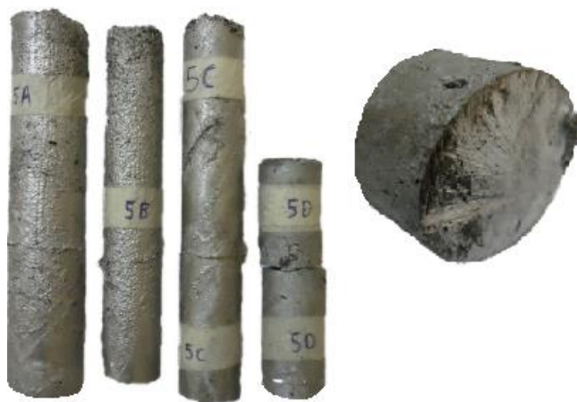
Figura 4.14. Lingotes de MC con corte y fractura del lingote 5D. (Fuente: Elaboración propia)
