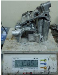
Figura 4.46. Preparación de la matriz Al-Si 365.0 al 93% (Fuente: Elaboración propia)
