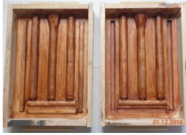
Figura 3.29. Fabricación del modelo de madera para la elaboración del molde de arena. (Fuente: Elaboración propia)
