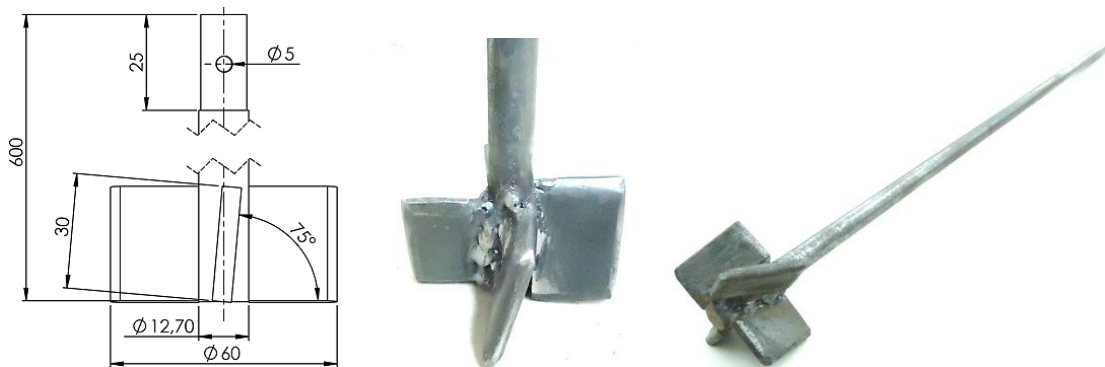
Figura 3.24. Diseño y construcción del agitador tipo paletas planas.
