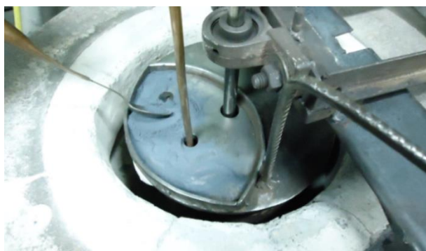
Figura 4.30. Polvo de SiC colocado en la tapa del crisol para adicionarlo a la matriz fundida. (Fuente: Elaboración propia)
