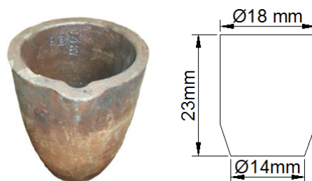
Figura 4.3. Crisol arcilla-grafito #18 marca diamant con sus debidas dimensiones. (Fuente: Elaboración propia)
