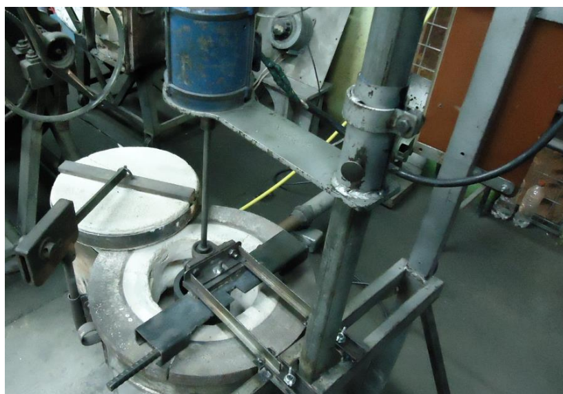
Figura 4.53. Centrado de las aspas del agitador en el interior del crisol de acero. (Fuente: Elaboración propia)
