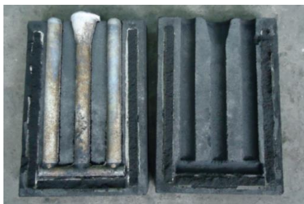
Figura 4.26. Molde de arena aglomerada y lingotes de MC 365.0/SiC/5p. (Fuente: Elaboración propia)
