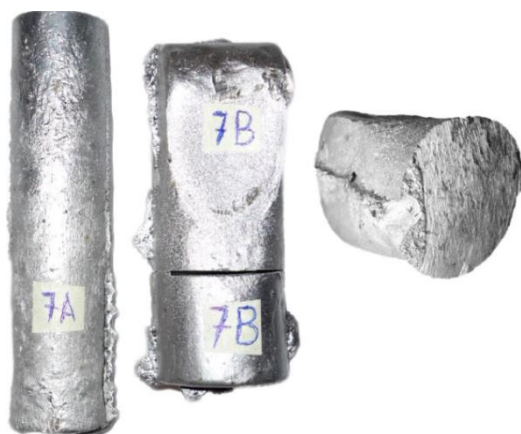
Figura 4.21. Lingotes de MC con corte y fractura del lingote 7B. (Fuente: Elaboración propia)
