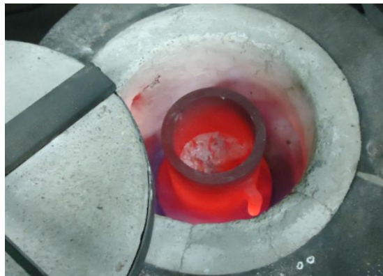
Figura 4.57. Fusión de la matriz Al-Si 365.0. (Fuente: Elaboración propia)
