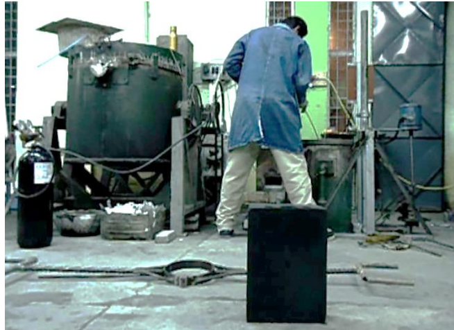
Figura 4.66. Desgasificación de la masa fundida mediante gas argón. (Fuente: Elaboración propia)
