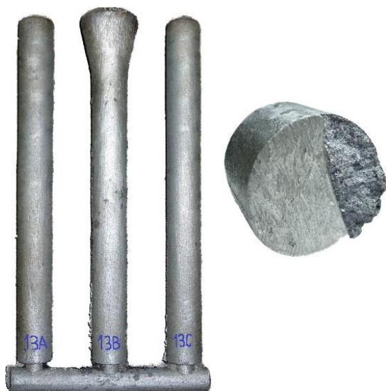
Figura 4.36. Lingotes de MC con corte y fractura del lingote 13A. (Fuente: Elaboración propia)
