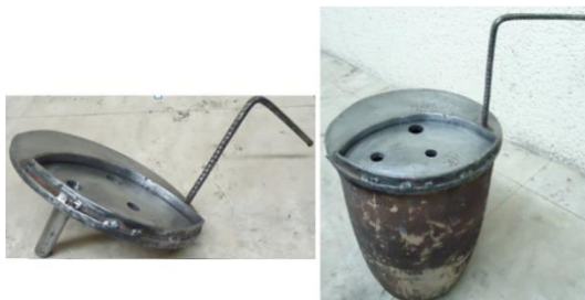
Figura 4.29. Tapa de acero del crisol. (Fuente: Elaboración propia)
