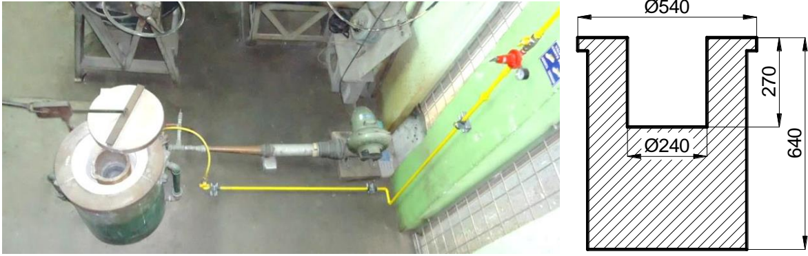
Figura 3.11. Horno de fundición alimentado por gas con crisol intercambiable. (Fuente: Elaboración propia)
