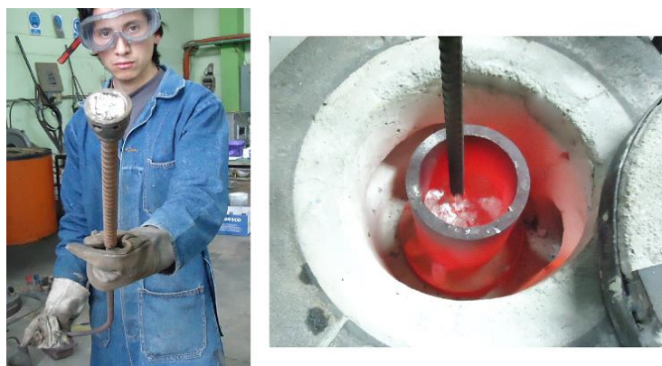
Figura 4.62. Introducción del escorificante alu fundex extra en la campana de hierro y posterior sumergimiento en la matriz fundida. (Fuente: Elaboración propia)
