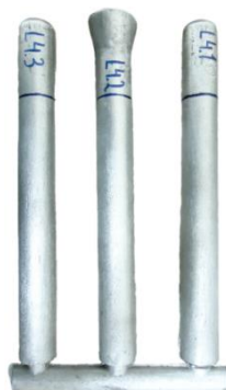
Figura 4.72. Lingotes obtenidos de MCM 365.0/SiC/6p. (Fuente: Elaboración propia)
