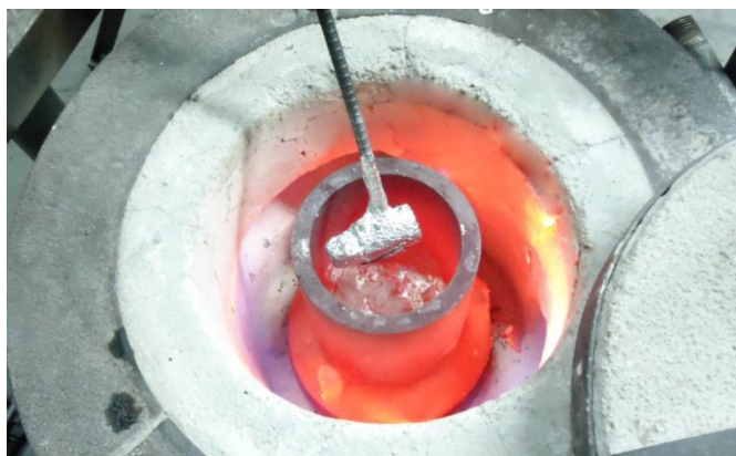
Figura 4.60. Introducción del pedazo de Mg sólido en la matriz fundida 365.0. (Fuente: Elaboración propia)
