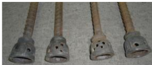
Figura 4.44. Detalle de las campanas de escorificación. (Fuente: Elaboración propia)
