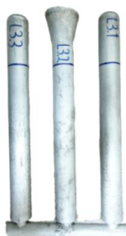
Figura 4.71. Lingotes obtenidos de MCMM 365.0/SiC/4p. (Fuente: Elaboración propia)
