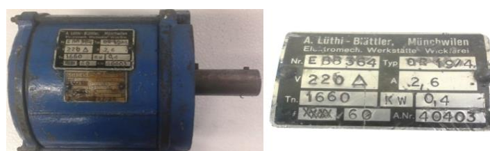
Figura 3.15. Motor eléctrico para la rotación del eje del agitador. (Fuente: Elaboración propia)
