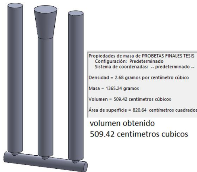
Figura 3.13. Volumen de la moldura de fundición para el cálculo de su masa. (Fuente: Elaboración propia)
