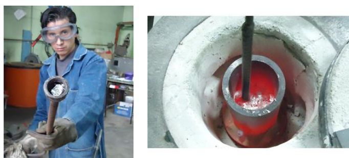
Figura 4.63. Introducción del apartagas H7-50 en la campana de hierro y posterior sumergimiento en la matriz fundida. (Fuente: Elaboración propia)
