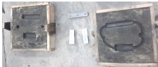
Figura 4.5. Molde de arena para colada horizontal. (Fuente: Elaboración propia)
