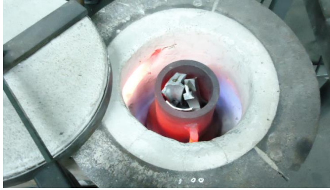
Figura 4.56. Introducción de la matriz 365.0 en el interior del crisol. (Fuente: Elaboración propia)
