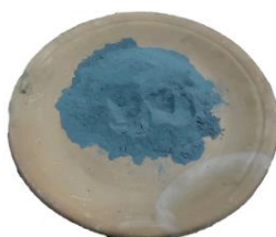
Figura 3.5. Polvo de SiC malla #400 para reforzar la matriz metálica 365.0. (Fuente: Elaboración propia)
