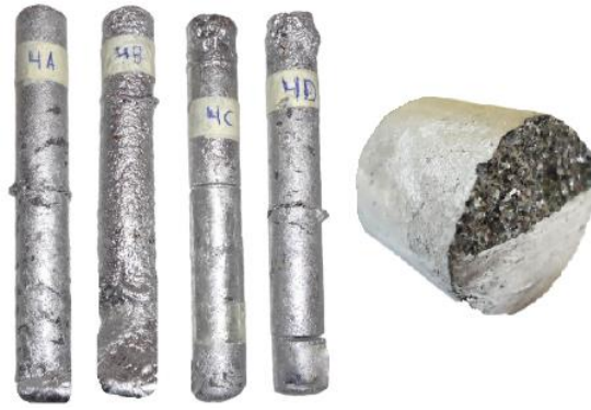
Figura 4.13. Lingotes de MC con corte y fractura del lingote 4C. (Fuente: Elaboración propia)
