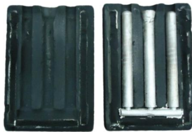
Figura 4.68. Extracción de los tres lingotes de MC 365.0/SiC/6p del molde de arena. (Fuente: Elaboración propia)
