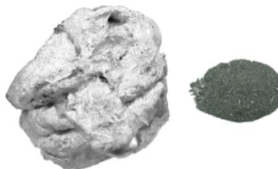
Figura 4.28. Residuo sólido del MC 365.0/SiC/5p y limallas obtenidas. (Fuente: Elaboración propia)
