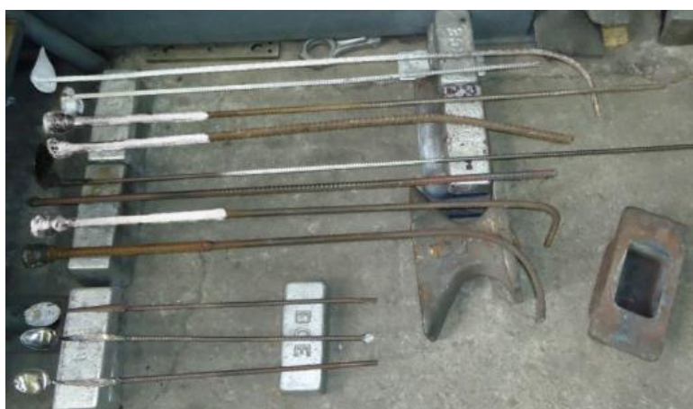
Figura 4.8. Herramientas construidas para el manejo de la fundición. (Fuente: Elaboración propia)
