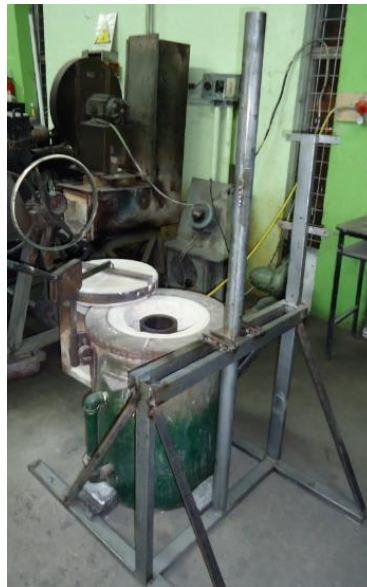
Figura 4.51. Montaje de la estructura del stir casting. (Fuente: Elaboración propia)
