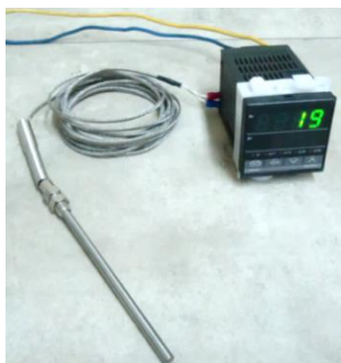
Figura 4.58. Controlador de temperatura digital con termocupla tipo probeta K. (Fuente: Elaboración propia)
