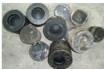
Figura 4.7. Pistones utilizados como material matriz en las pruebas preliminares. (Fuente: Elaboración propia)
