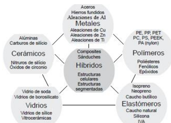
Figura 2.1. Clasificación actual de los materiales incluidos los composites según Ashby. (Fuente: Ashby, 2011, p. 340 [30])
