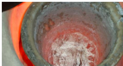
Figura 4.23. Óxido de magnesio formado sobre la superficie de la matriz fundida. (Fuente: Elaboración propia)
