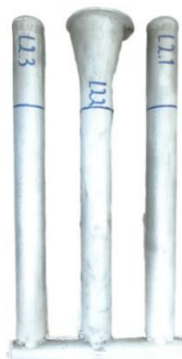
Figura 4.70. Lingotes obtenidos de MCM 365.0/SiC/2p. (Fuente: Elaboración propia)
