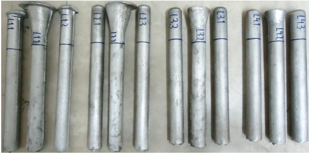
Figura 4.73. Lingotes cilíndricos previa preparación de probetas. (Fuente: Elaboración propia)
