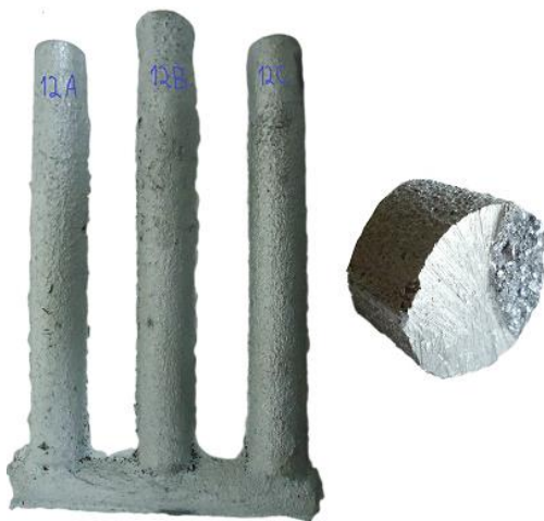
Figura 4.32. Lingotes de MC con corte y fractura del lingote 12C. (Fuente: Elaboración propia)
