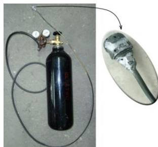
Figura 4.35. Campana de argón construida con conexión a su tanque. (Fuente: Elaboración propia)
