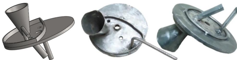
Figura 3.22. Diseño y construcción de la tapa del crisol. (Fuente: Elaboración propia)
