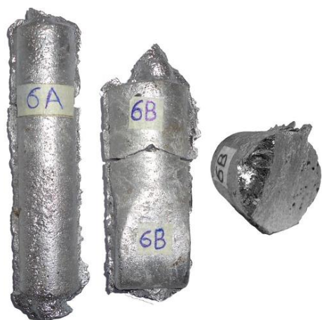
Figura 4.16. Lingotes de MC con corte y fractura del lingote 6B. (Fuente: Elaboración propia)
