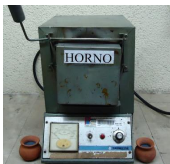
Figura 4.18. Horno de resistencia eléctrica con los recipientes utilizados para calentar el SiC. (Fuente: Elaboración propia)
