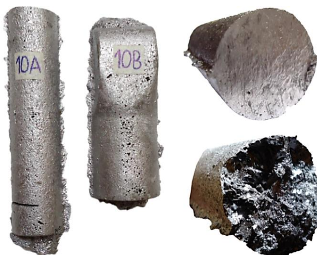
Figura 4.25. Lingotes de MC con corte transversal y una fractura en el lingote 10A. (Fuente: Elaboración propia)
