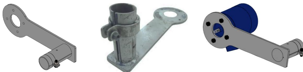
Figura 3.17. Estructura solidaria del motor eléctrico. (Fuente: Elaboración propia)
