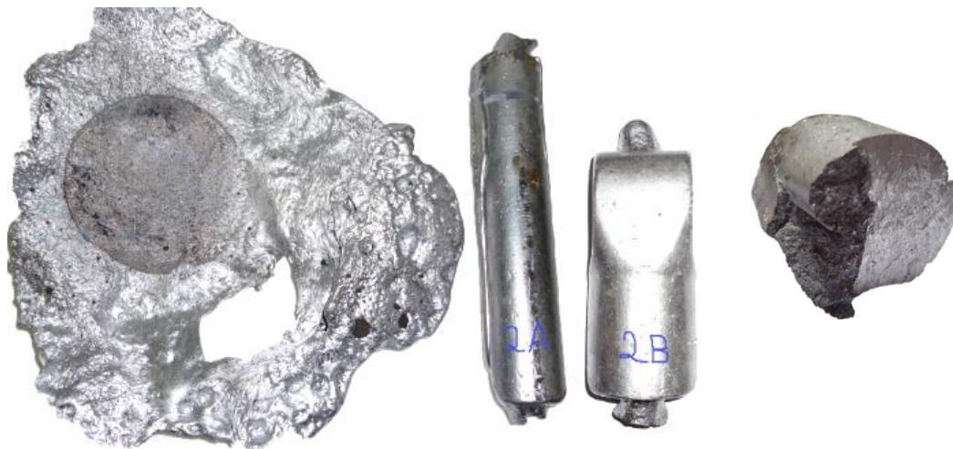
Figura 4.10. Lingotes de MC con masa residual además del corte y fractura del lingote 2A. (Fuente: Elaboración propia)
