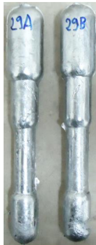
Figura A21.2. Lingotes obtenidos de MC C-365.0/SiC/6p colado en coquilla de acero. (Fuente: Elaboración propia)
