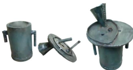
Figura 4.34. Crisol de acero con su tapa. (Fuente: Elaboración propia)
