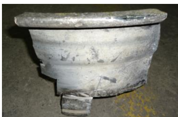
Figura 4.24. Aro de rueda de aleación Mg-Al (93%Mg-7%Al). (Fuente: Elaboración propia)
