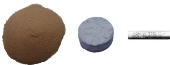
Figura 3.6. Fundentes alu fundex extra (rosado) apartagas H7-50 (azul) y Al5TiB (plateado). (Fuente: Elaboración propia)
