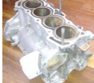
Figura 4.38. Block de cilindros Al-Si 365.0 removido la suciedad superficial. (Fuente: Elaboración propia)
