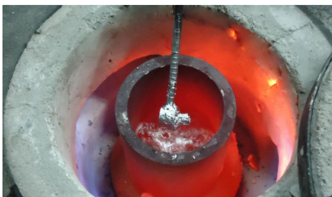
Figura 4.61. Introducción del pedazo de Al5TiB sólido en la matriz fundida 365.0. (Fuente: Elaboración propia)
