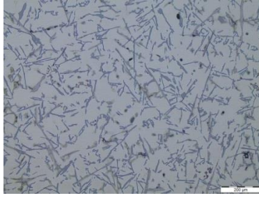
Figura 5.1. Microestructura de la matriz 365.0 con aumento a 100X. (Fuente: Elaboración propia)
