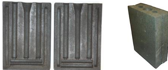
Figura 3.30. Molde de arena aglomerada con resina orgánica autofraguante. (Fuente: Elaboración propia)
