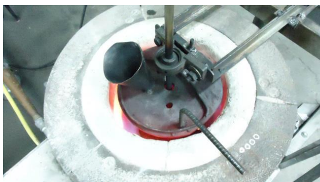
Figura 4.64. Introducción de aspas en la matriz fundida 365.0 y colocación de la tapa en el crisol. (Fuente: Elaboración propia)
