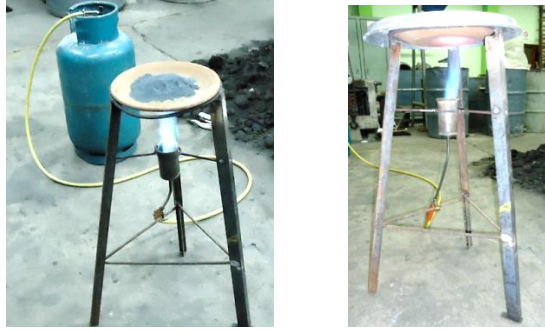
Figura 4.4. Estructura de acero para el calentamiento del polvo de SiC en plato de arcilla. (Fuente: Elaboración propia)
