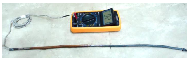
Figura 4.59. Multímetro DT9208A con termocupla tipo K. (Fuente: Elaboración propia)
