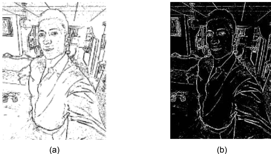
Figura 2.37. Resultados obtenidos para el ejemplo de detección de bordes empleando el gradiente espacial Laplaciano, (a) Bordes en negro (ceros), (b) Bordes en blanco (unos).
