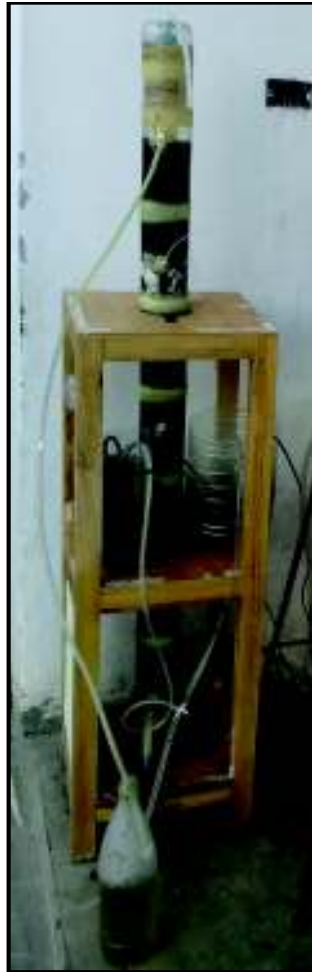
FIGURA 4.7 ACONDICIONAMIENTO DE LOS LODOS ANAEROBIOS.
