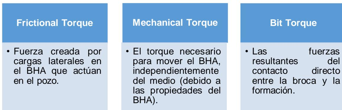
**Figura 1.17** Diagrama de Tipos de torque
