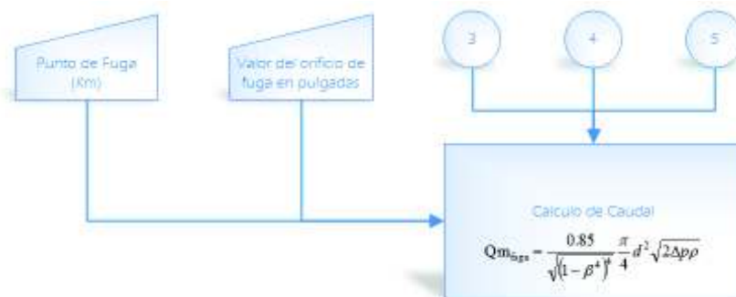
Figura 3.6 Diagrama de flujo – Detección de Fuga
