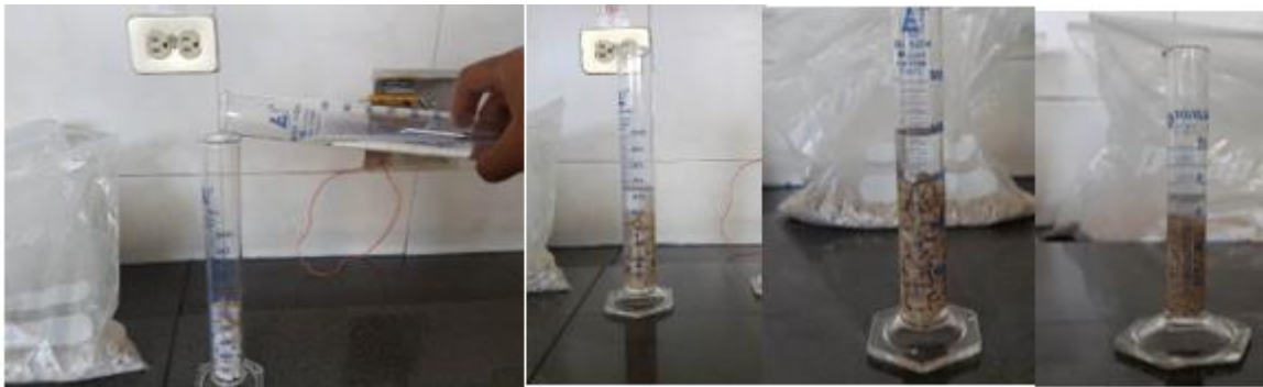
FIGURA 3.9 AGUA COLOCADA PARA DESALOJAR EL AIRE EN EL LECHO
