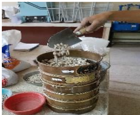
FIGURA 3.3 COLOCACION DE LA MUESTRA SOBRE LOS TAMICES.
