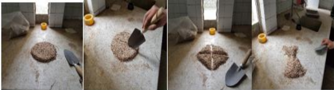
FIGURA 3.2 CUARTEO DE MUESTRA DE MÁRMOL
