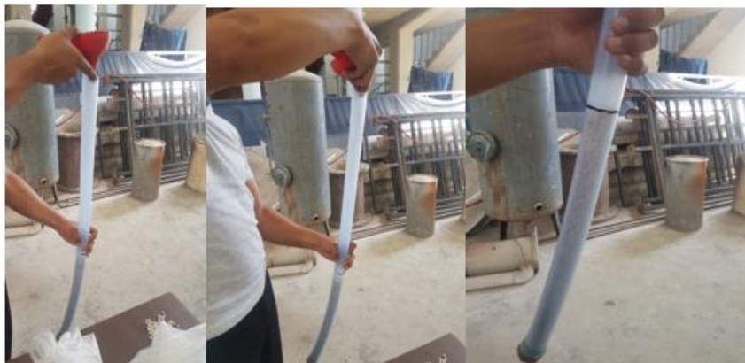
FIGURA 3.12 COLOCACIÓN DE TANDAS DE MARMOL PARA CADA EXPERIMENTACIÓN
