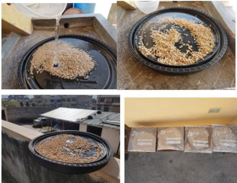
FIGURA 3.6 LAVADO Y SECADO DEL MARMOL
