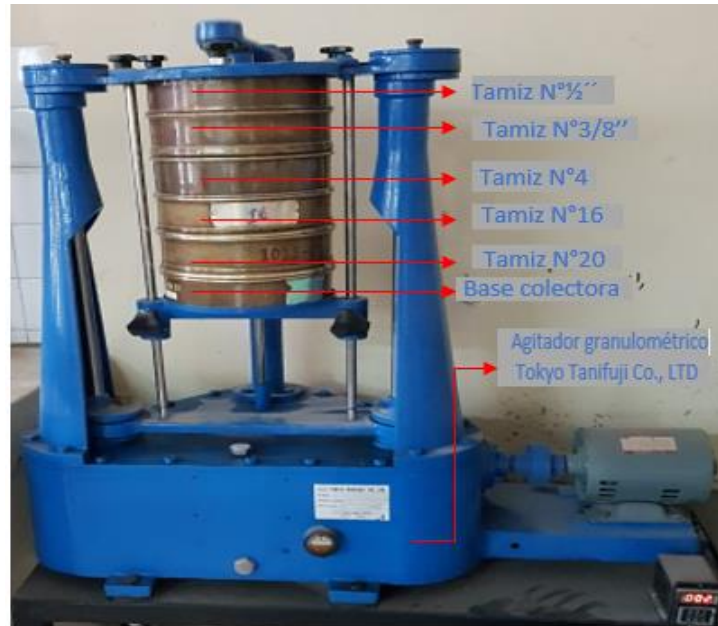
FIGURA 3.4 TAMIZADO DE LA MUESTRA
