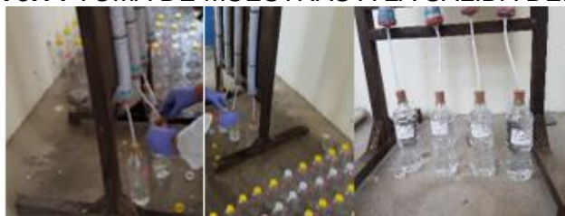
FIGURA 3.14 TOMA DE MUESTRAS A LA SALIDA DEL LECHO
