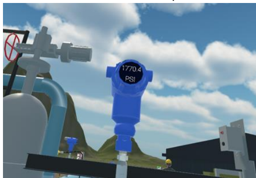
Figura 5.12. Presión 2 a 50% de apertura de válvula B.
