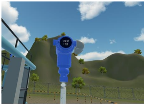
Figura 5.17. Presión 1 a 100% de apertura de todas las válvulas.
