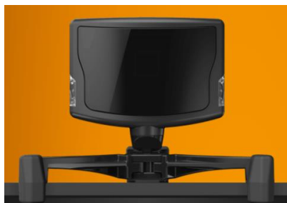
Figura 1.12. TrackIR 5: dispositivo de entrada head tracking.
