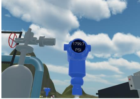
Figura 5.18. Presión 2 a 100% de apertura de todas las válvulas.
