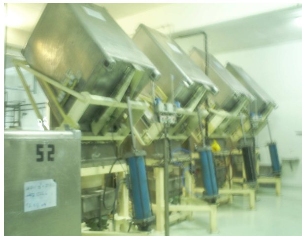
Figura 7: Fotografía de totes alimentando a las tolvas de llenado.
