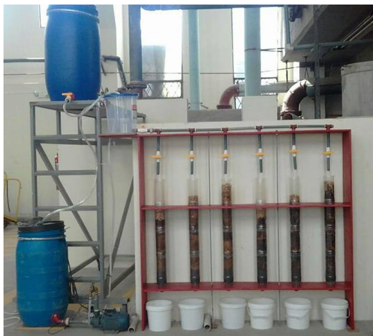
FIGURA 3.6: SISTEMA DE BIOFILTRACIÓN
