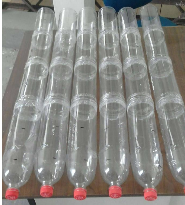
FOTO A3.6: MATERIAL DE CONSTRUCCIÓN DE LOS BIOFILTROS DE PLÁSTICO DE BOTELLAS RECICLADAS DE POLIETILENO TEREFTALATO (PET)
