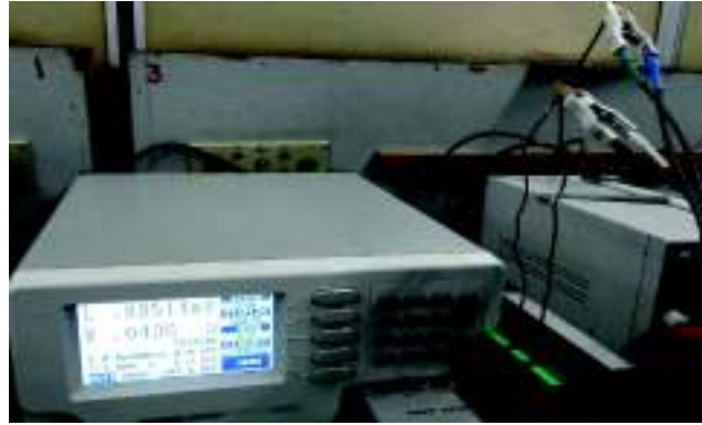
Figura 3.7. Medición de inductancia de la bobina de núcleo de hierro de la fase c
