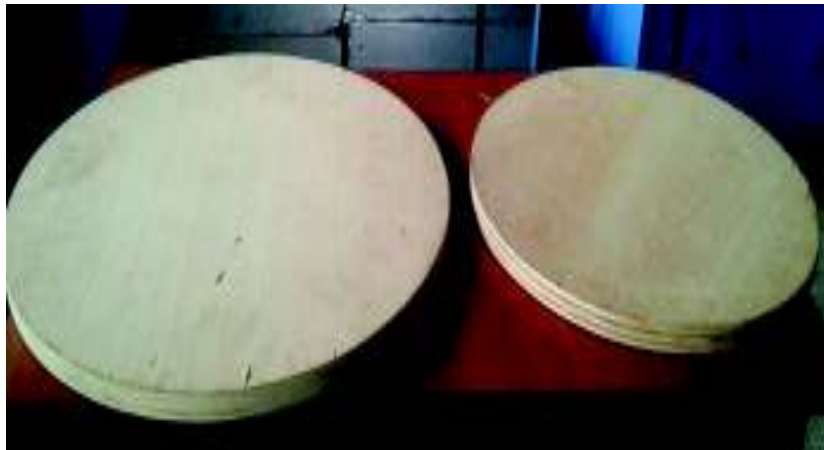
Figura 2.14. Moldes utilizados para el bobinado
