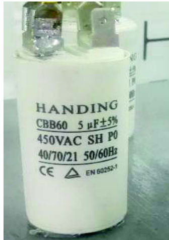
Figura 2.25. Capacitores tipo CBB60, utilizados en la representación del modelo electrostático
