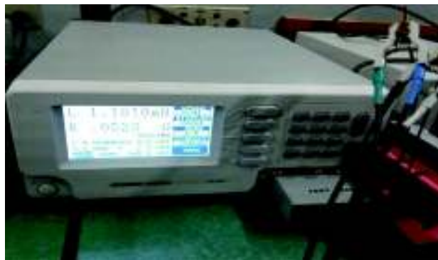
Figura 3.5. Medición de inductancia de la bobina de núcleo de hierro de la fase a
