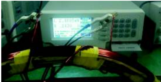
Figura 3.3. Medición de inductancia de la bobina de núcleo de aire de la fase b
