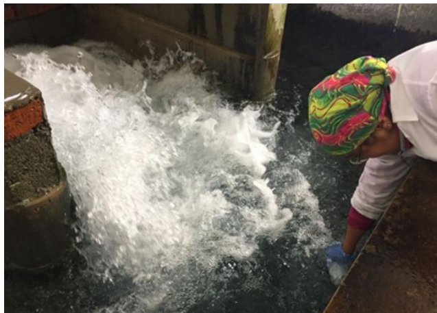
FIGURA 21: TOMA DE MUESTRA EN EL TANQUE REPARTIDOR
