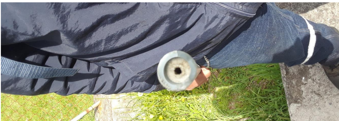
FIGURA 51: TUBERÍA DEL SISTEMA DE GOTEO CON ACUMULACIÓN DE CLORO
