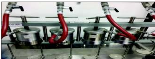
Equipo de filtrado API
