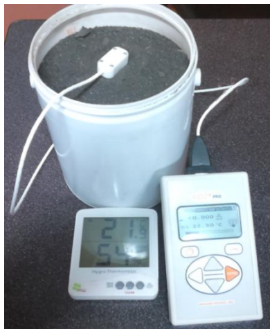
Foto 4.5. Medición con el dispositivo KD2 Pro de conductividad y resistencia térmica del polvo de roca volcánica.
