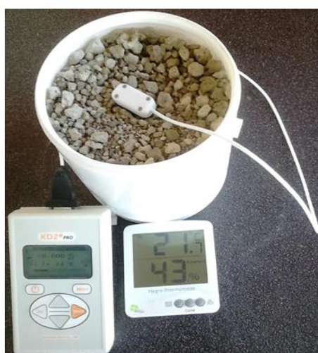
Foto 4. 6. Medida de conductividad y resistencia térmica del cascajo.
