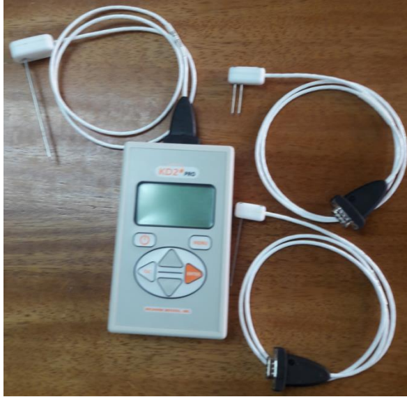
Foto 3. 1. Dispositivo KD2 Pro, con sus tres sensores. (Fuente: Edison Pachacama & Juan Obando, 2017)
