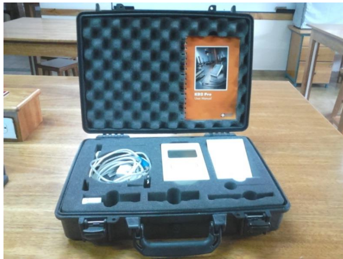
Foto 3. 2. Dispositivo portátil KD2 Pro. (Fuente: Edison Pachacama & Juan Obando, 2017)
