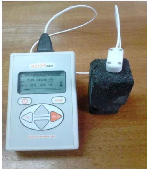
Foto 4.4. . Medición con el dispositivo KD2 Pro de conductividad y resistencia térmica de la roca volcánica.
