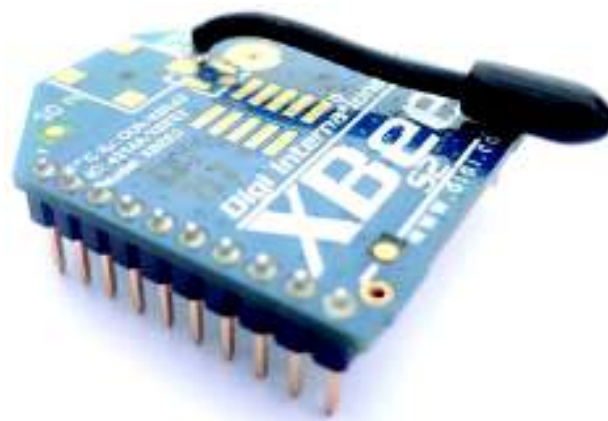
Figura 3.18. Módulo Xbee serie 2 [Autoría Propia]
