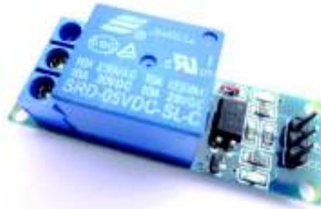
Figura 3.16. Módulo Relé [Autoría Propia]
