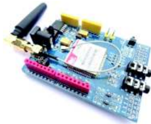
Figura 3.23. Módulo GSM/GPRS SIM900 para Arduino [Autoría Propia]
