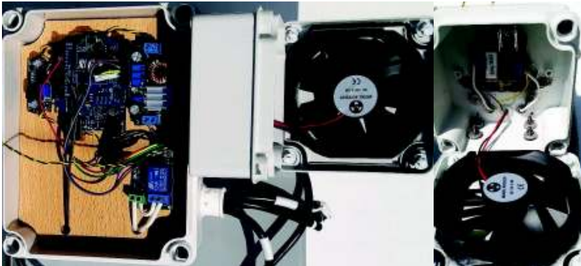
Figura 3.27. Vista real del tercer prototipo controlador de nodo (Versión Final) [Autoría Propia]
