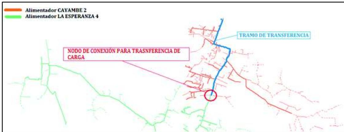
**Figura 3.6.** Nodo de conexión entre alimentadores Cayambe 2 y La Esperanza 4
