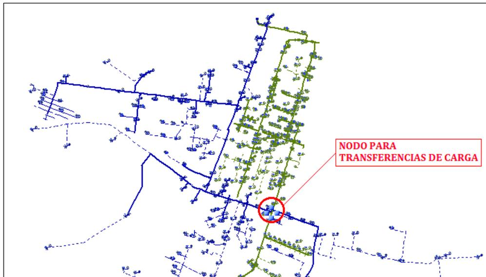
**Figura 3.8.** Nodo de conexión entre alimentadores Cayambe 1 y Cayambe 2
