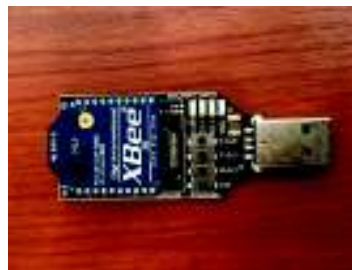
Figura 2.22 Conexión de XBee sobre el gateway
