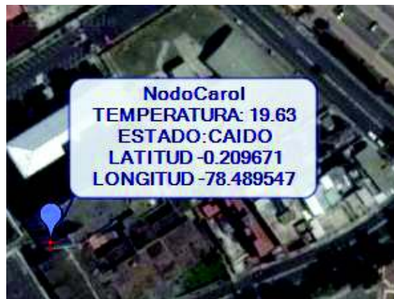
Figura 3.24 Alarma de estado caído
