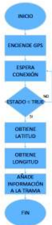
Figura 2.16 Diagrama de flujo de la programación del GPS
