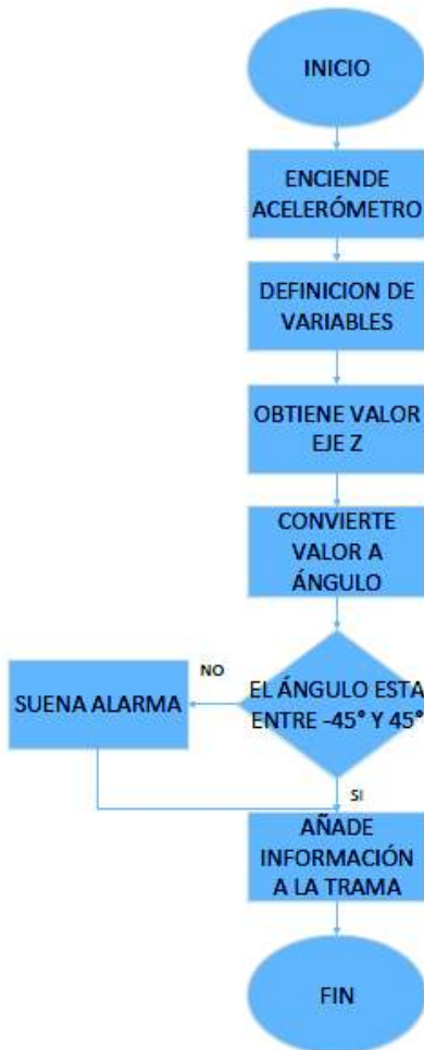
Figura 2.17 Diagrama de flujo de la programación del acelerómetro
