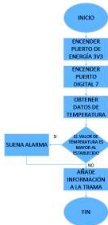
Figura 2.20 Diagrama de flujo de la programación del sensor de temperatura
