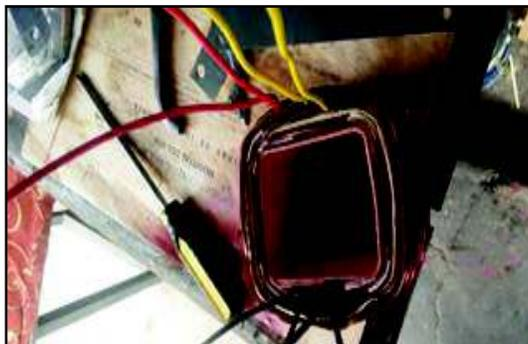
**Figura 79.** Bobinado completo primarios y secundarios.
