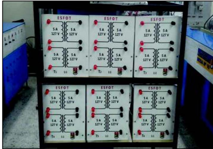
**Figura 1-2.** Transformadores monofásicos en su estructura soporte.
