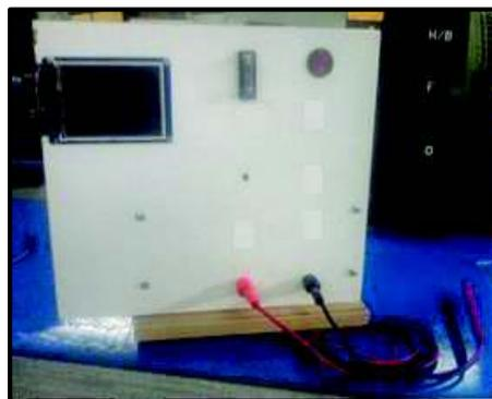
**Figura 1-12.** Puntas de voltaje para obtener la señal de voltaje.
