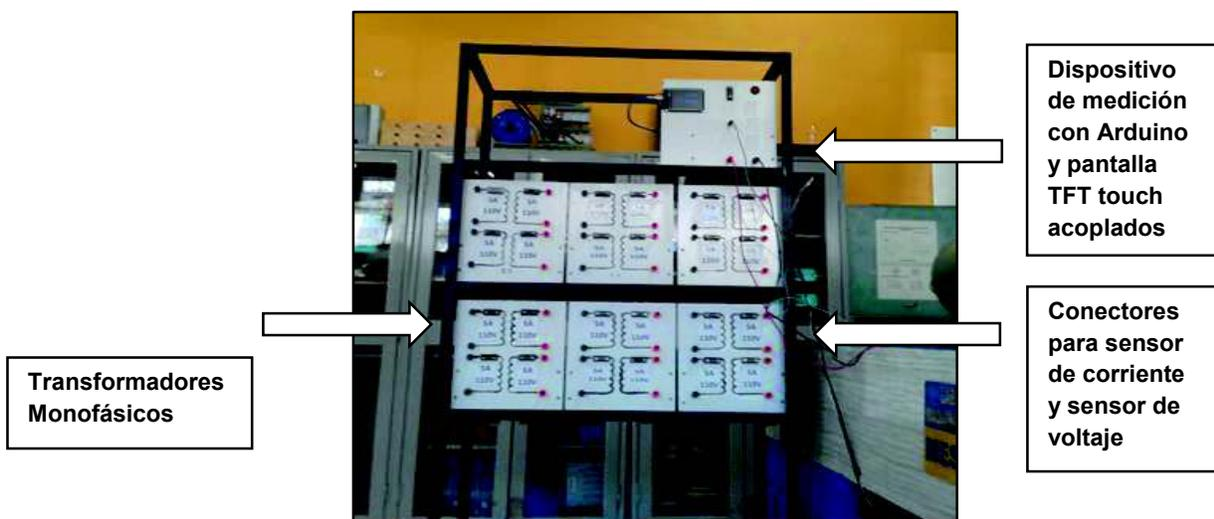
Figura 91. Módulo de transformadores.
