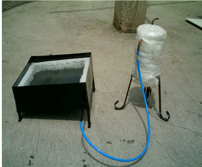
Figura N° 4.3: Colector y depósito o tanque de reserva
