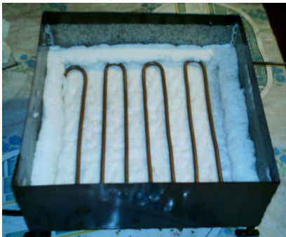
Figura N° 4.1: Ubicación del serpentín terminado
