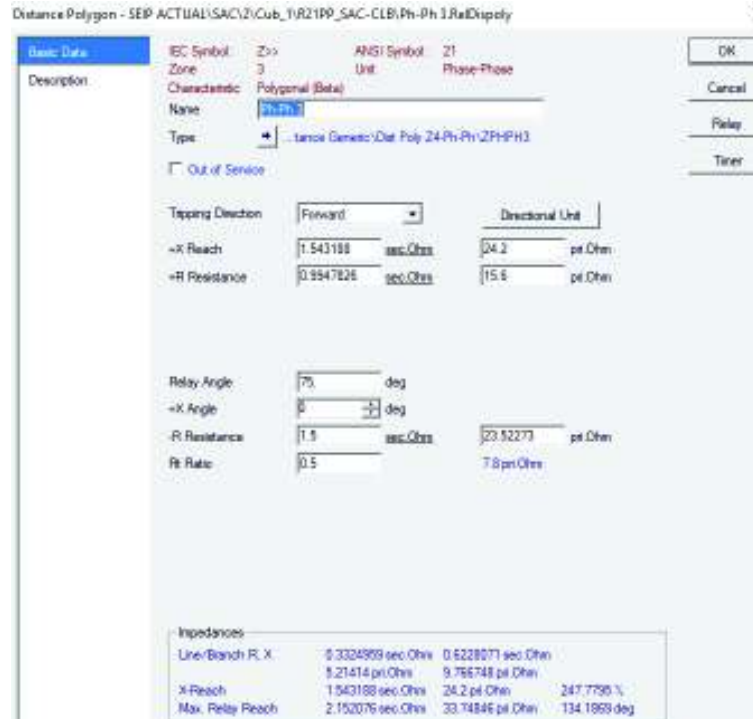
Figura 4.32. Ajustes de la zona 3 del relé de distancia tomado como ejemplo [Impresión de PowerFactory]
