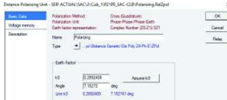
Figura 4.33. Ingreso del valor k_0 en el relé de neutro (21N) [Impresión de PowerFactory]
