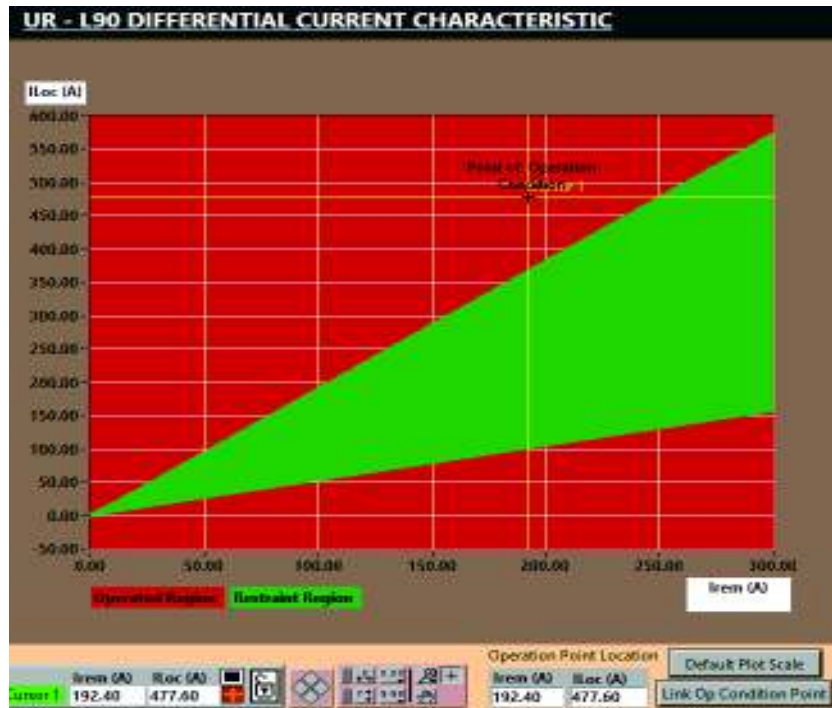
Figura 4.8. Curva característica de operación del relé GE UR-L90 en el programa LabVIEW (proporcionado por el fabricante) [Elaboración propia]
