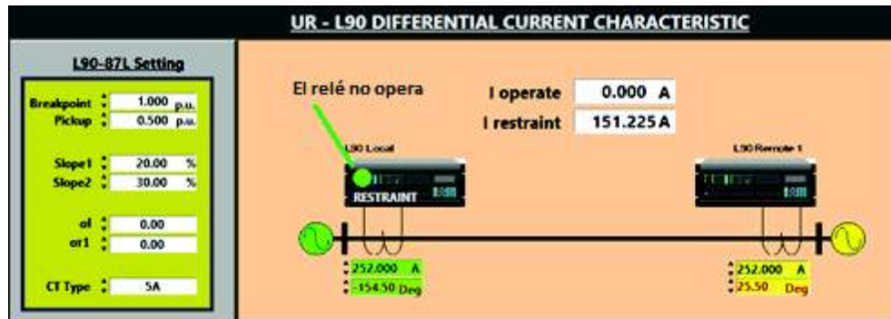
Figura 4.10. Operación del relé GE UR-L90 ante una falla externa a la línea de subtransmisión protegida [Elaboración propia]
