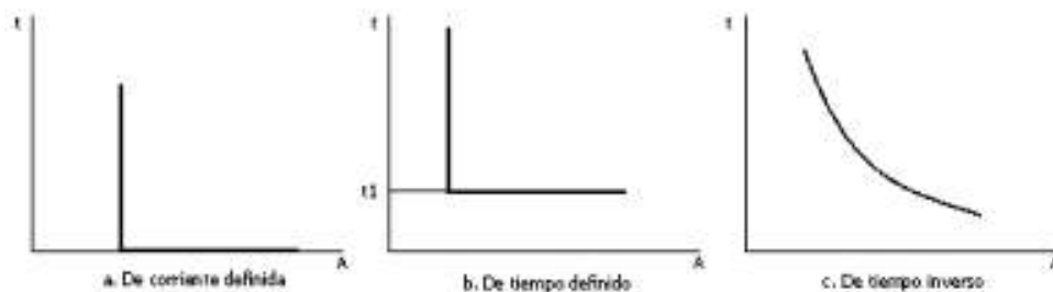
Figura 2.15. Curvas características de operación de relés de sobrecorriente. Diagrama tiempo vs corriente [11]
