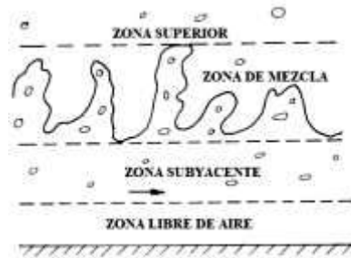
Figura 2.22 Estructura vertical del ingreso de aire
