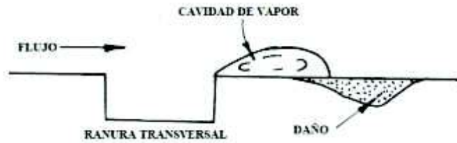
Figura 2.31 Daño por cavitación debido a ranura transversal
