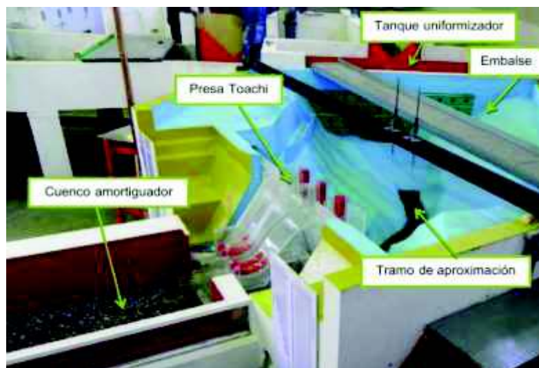
Figura 3.2 Modelo físico de la Presa Toachi, escala 1:50
