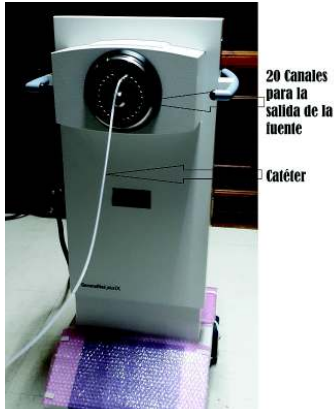
Figura 3.1: Sistema de carga remota GammaMed Plus iX comercializado por Varian Medical Systems (Palo Alto, USA). SOLCA Nucleo-Quito
