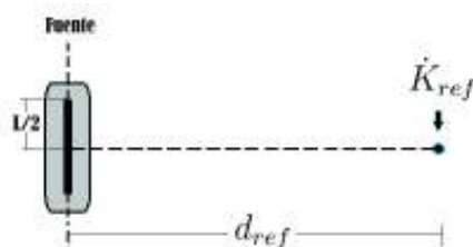
Figura 2.3: Geometría para la definición de la Intensidad de Kerma en Aire.
