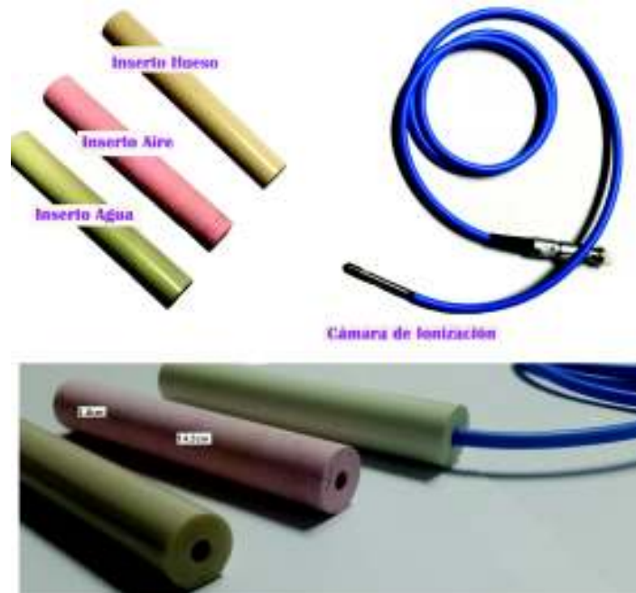
Figura 3.4: Insertos y cámara de ionización para la validación del algoritmo.
