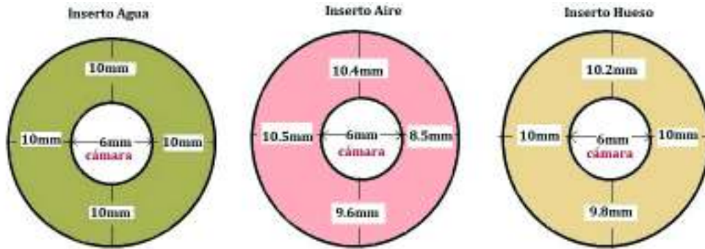
Figura 3.9: Esquema de la posición de la cámara ionización en cada uno de los tres insertos.
