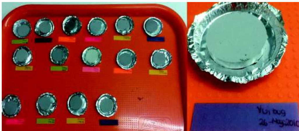
Figura 19.- Pastillas de las cenizas volcánicas en el INPC.
