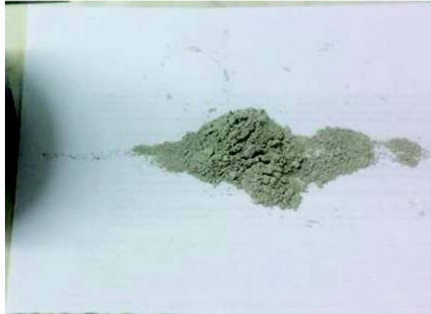
Figura 18.- Ceniza pulverizada en el micronizador para el análisis EDS.
