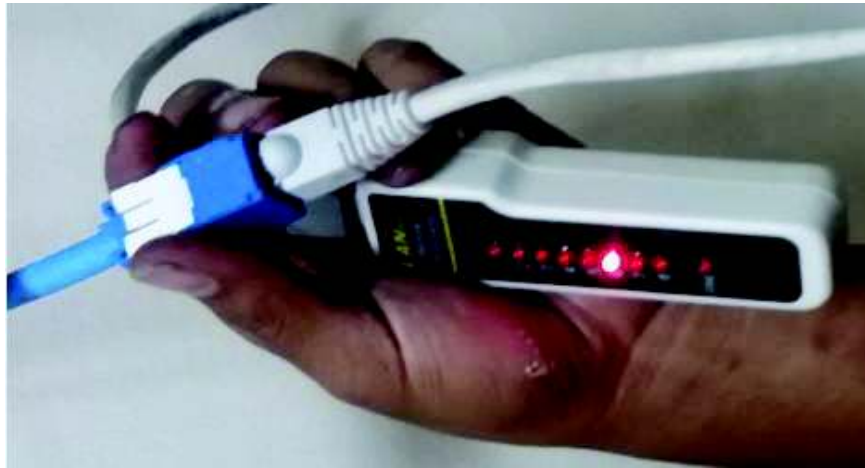
Figura 3.28 Prueba con LAN Tester
