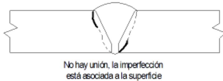
Figura 1.6. Esquema de fusión incompleta. (Fuente: Autores)
