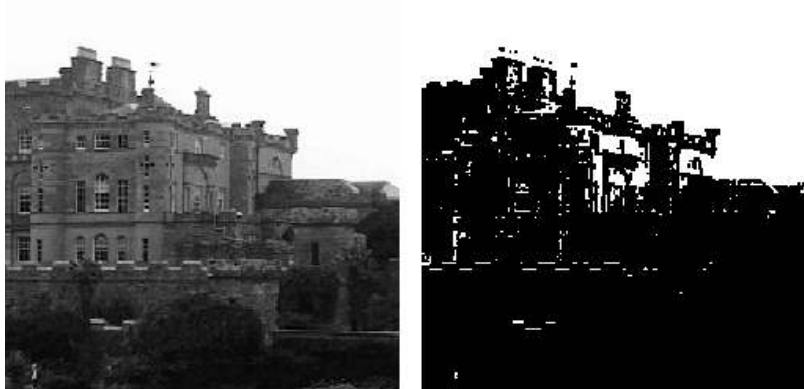
Figura 1.23. Efecto de la cuantificación. De izquierda a derecha: 8 y 1 bit. (Fuente: EDMANS, 2006)
