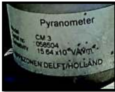
Figura 3. 2. Placa del piranómetro instalado en la estación meteorológica de Belisario. (Fuente: Propia)
