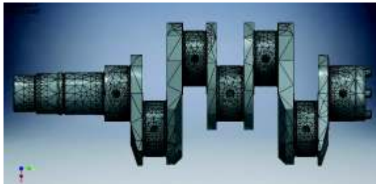
Figura 2.8. Malla automática generada en Inventor. (Fuente Propia)
