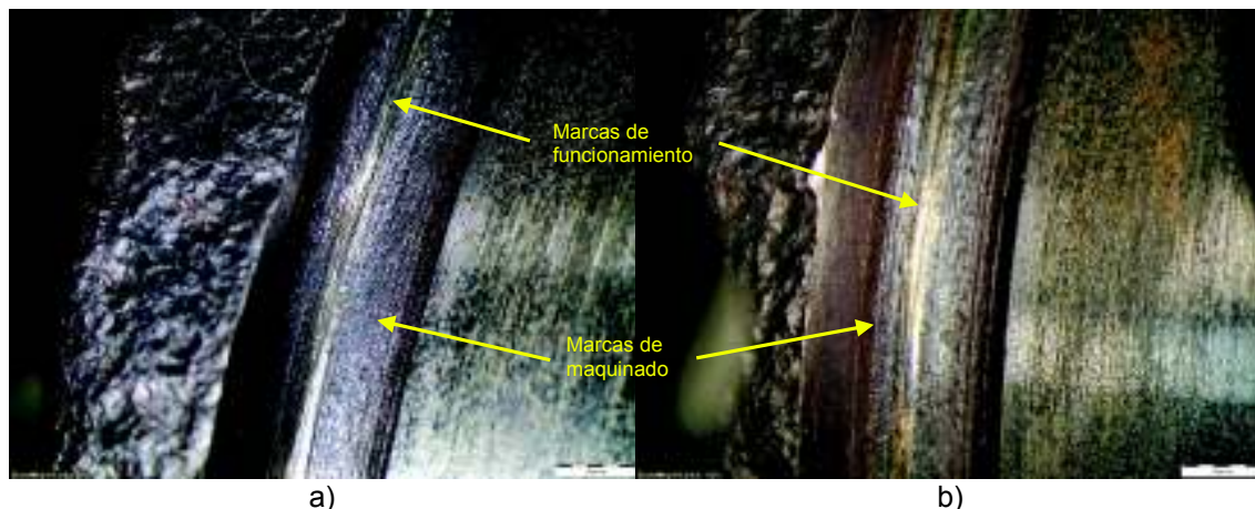
Figura 3.5. Marcas de funcionamiento y de conformado mecánico, a)8X, b)8X. (Fuente Propia)
