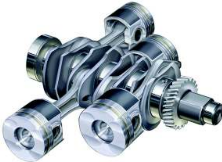
Figura 2.12. Distribución de las bielas y pistones en el cigüeñal. (Fuente Garcia, 2013)
