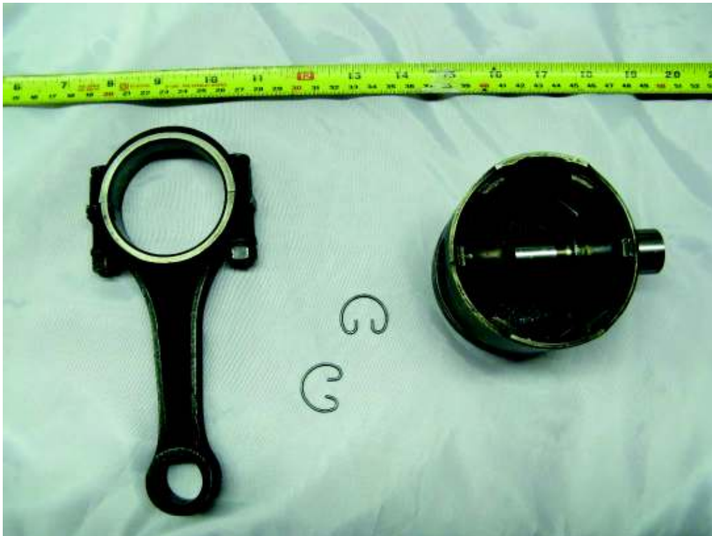
Figura 2.15. Pistón y biela para un motor de un Volkswagen Kombi. (Fuente Propia)
