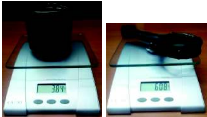
a) b) Figura 2.16. Pesos pistón y biela para un motor de un Volkswagen Kombi, a) Pistón, b) Biela. (Fuente Propia)
