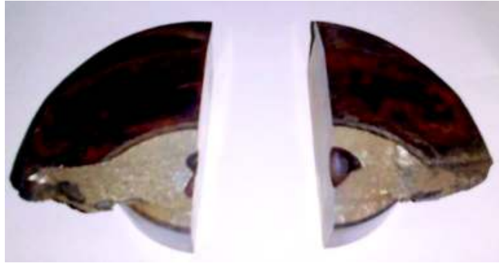
Figura 2.4. Probetas para los ensayos metalográficos. a) C-N, b) C-V. (Fuente Propia)
