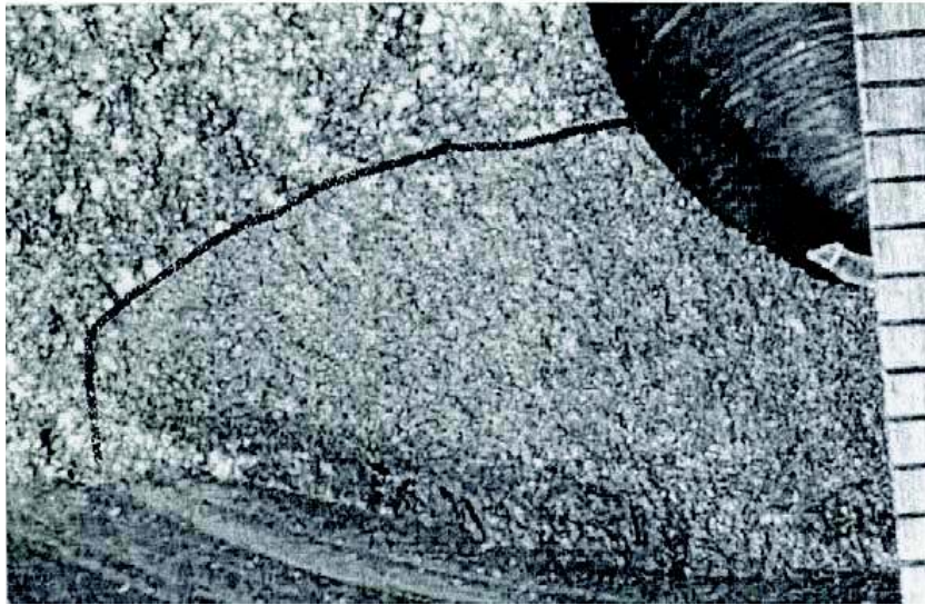
Figura 1.8. Cigüeñal de un motor V-6, falla a una resonancia de 2 Hz, fractura de 9.5 mm. (Fuente Spiteri, Lee, & Segar, 2005)
