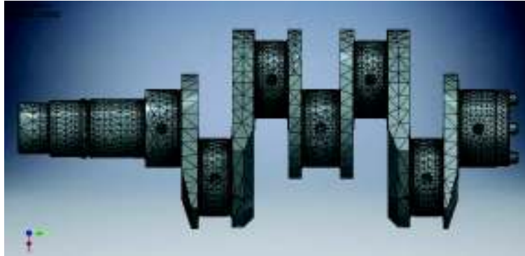
Figura 2.10. Malla refinada generada en Inventor. (Fuente Propia)
