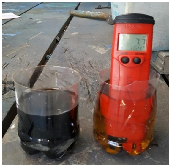
Figura 3.21. Medición de pH agua residual tratada
