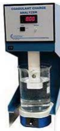
Figura 2.15. Analizador de Cargas Chemtrac CCA-3100 [26]
