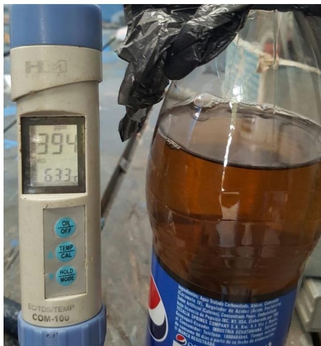
Figura 3.35. Medición TDS agua tratada
