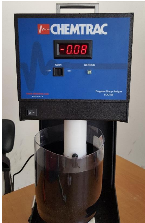
Figura 3.17. Lectura de carga con Ganancia alta
