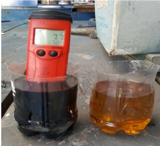
Figura 3.20. Medición de pH agua residual sin tratar
