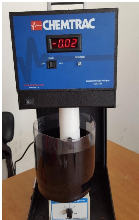
Figura 3.16. Lectura de carga con ganancia baja
