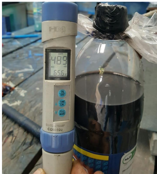
Figura 3.34. Medición TDS agua residual
