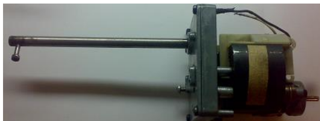
Figura 2.6. Fotografía del motor con motor reductor incorporado.
