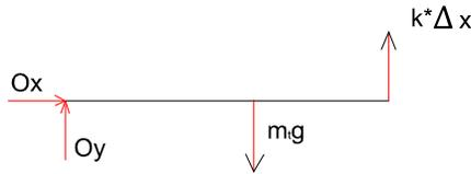
Figura 2.42. Diagrama de cuerpo libre del sistema de barra simplemente apoyada, en estado estable.
