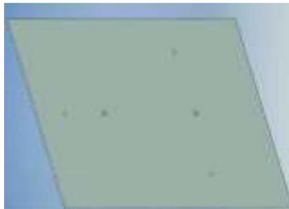
Figura 2.13. Placa metálica sólida con agujeros para soporte de suspensión trifilar.
