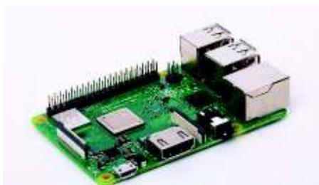
Figura 2.16. Tarjeta de control marca Raspberry pi.
