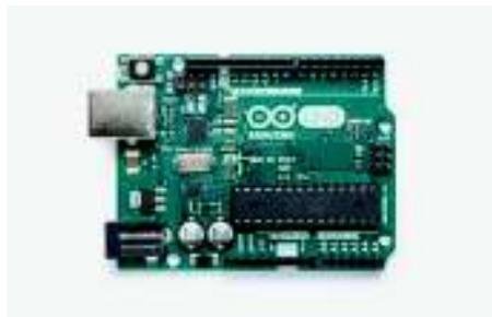
Figura 2.14. Tarjeta de control Arduino.
