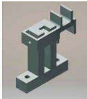
Figura 2.26. Modelo del soporte para foto tacómetros, utilizado en la medición de la práctica de balanceo estático.
