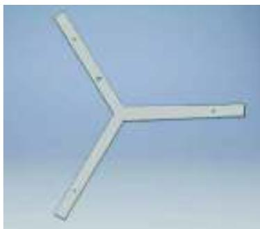
Figura 2.12. Estructura de barras rígidas para suspensión trifilar.
