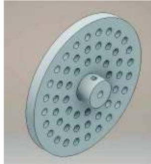
Figura 2.25. Modelo para la fabricación de rotor, utilizado en la práctica de balanceo estático.
