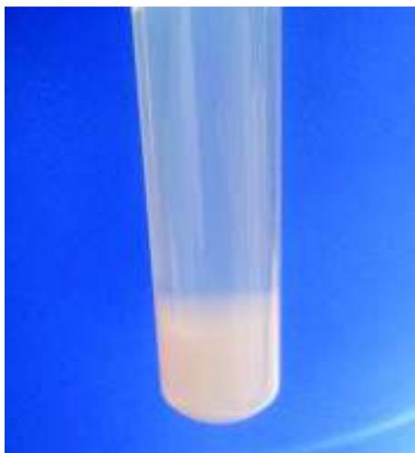
**Figura 3.7** Precipitado de celulosa a pH neutro
