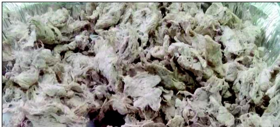
**Figura 3.1** Pulpa de celulosa de puntas de abacá obtenidas mediante digestión con NaOH
