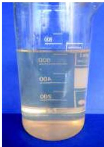
**Figura 3.10** Suspensión coloidal ácida obtenidas con 30 minutos de hidrólisis y relación ácido/celulosa de 13 mL/g
