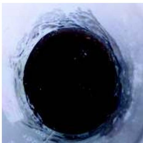
**Figura 3.6** Sedimento de celulosa formado en la etapa 4 del proceso de obtención de nanocelulosa
