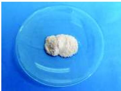
**Figura 3.16** Nanocelulosa obtenida mediante hidrólisis con  $H_2SO_4$
