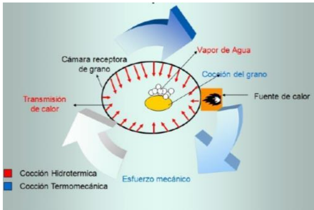
Figura 3.3. Proceso de expansión de granos y cereales (Villacrés, Salazar, Peralta y Ruilova, 2009, p. 10)
