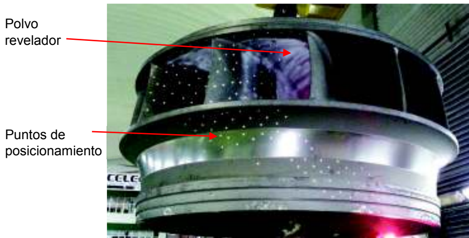
Figura 2.3. Rodete Francis de la central hidroeléctrica San Francisco con superficies preparadas para la digitalización. (Fuente: CIRT)
