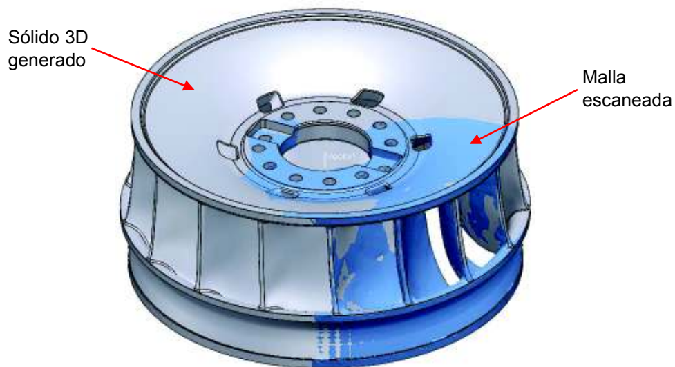
Figura 1.20. Obtención de la geometría de un rodete a partir de un escaneo 3D. (Fuente: Propia)
