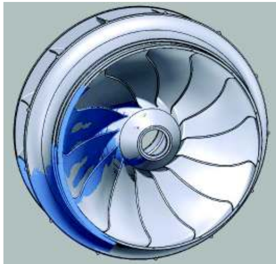
Figura 2.7. Rodete Francis de la central San Francisco generado a partir de datos de escaneo. (Fuente: CIRT)
