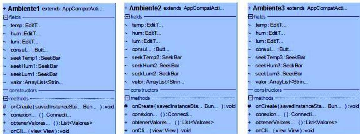
Figura 2.8 Diagrama de clases de la aplicación Android
