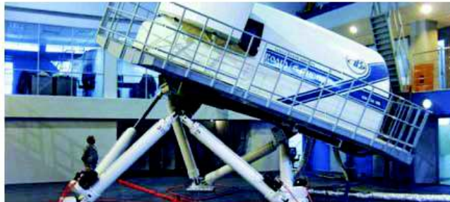
Figura 1.10. Simulador de vuelo, Rexroth. (Fuente: (Briot & Khalil, 2015))
