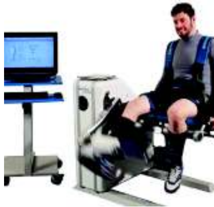
Figura 1.1. Robot Genu PLUS para la flexión-extensión de rodilla. (Fuente: http://easytech-website-prod.s3.amazonaws.com/2015/04/29/09/46/41/627/IMG_2131.jpg )
