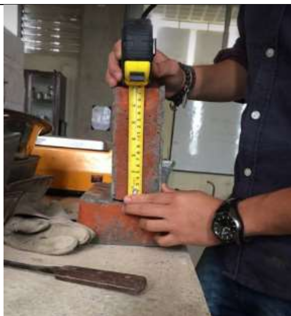
Fotografía 34. Medición de las dimensiones del ladrillos
