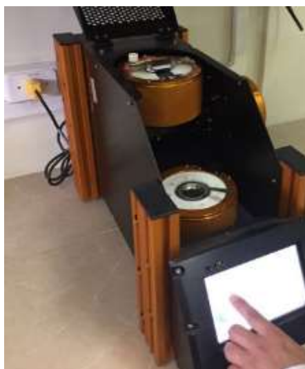
FIGURA 2.11 Elaboración de perla fundida
