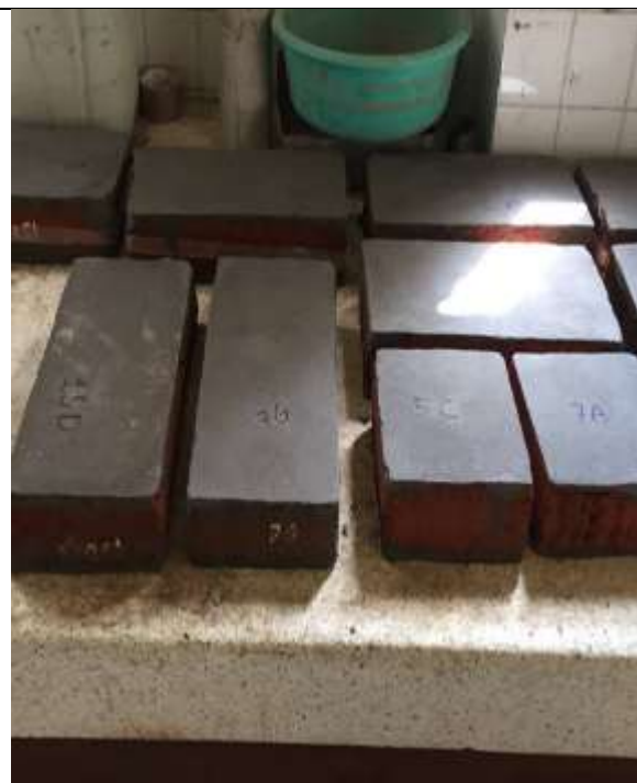
Fotografía 36. Revestido de los ladrillos para el ensayo de compresión
