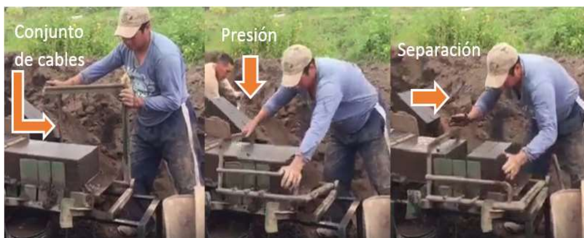
FIGURA 2.23 Cortado de pasta de ladrillo
