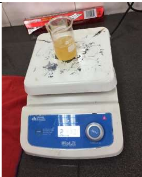
Fotografía 26. Preparación del medio nutritivo Agar.
