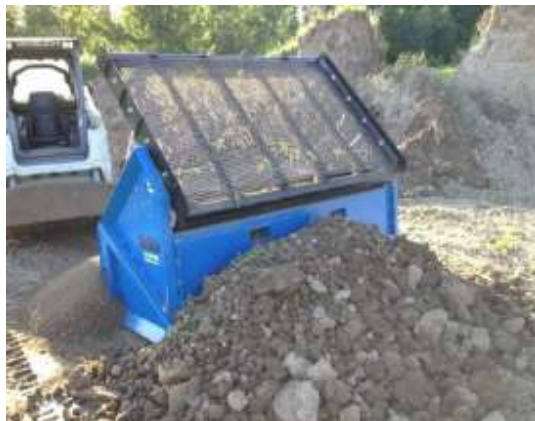
FIGURA 2.19 Tamizado del suelo
