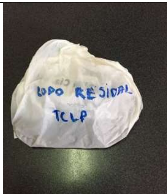
Fotografía 25. Muestra de lodo para ensayo TCLP.
