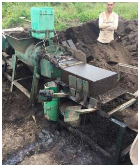
Fotografía 11. Maquinaria para elaborar ladrillos.
