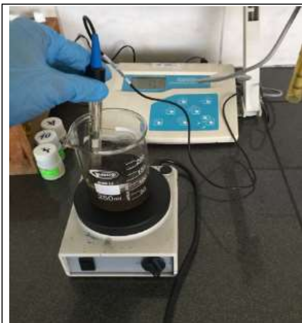
Fotografía 20. pH de la muestra de lodo.
