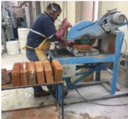
FIGURA 2.26 Cortado de las muestras de ladrillos
