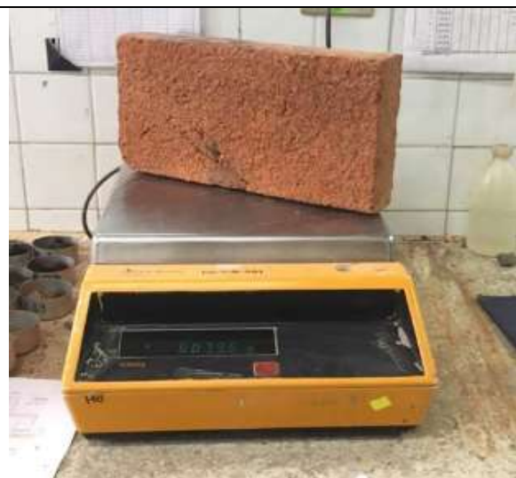
Fotografía 33. Pesado de los ladrillos
