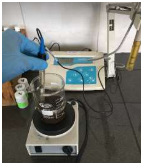
FIGURA 2.13 Ensayo de corrosividad
