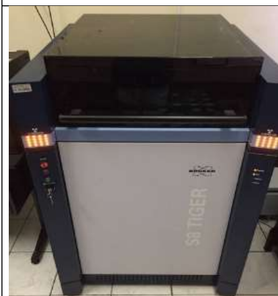
Fotografía 30. Espectrofotómetro de Florescencia de Rayos X S8 Tiger.
