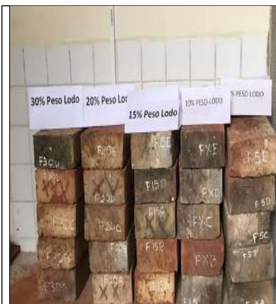
Fotografía 13. Ladrillos de mezcla cocidos.
