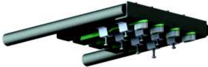
Figura 2.6. Cepillos sujetos mediante abrazaderas trapezoidales. (Fuente: Propia)
