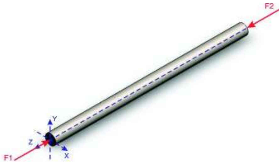
Figura 2.32. Fuerzas actuantes sobre el brazo de la biela.
