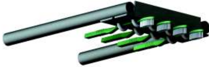
Figura 2.8. Cepillos sujetos mediante abrazaderas tipo U. (Fuente: Propia)
