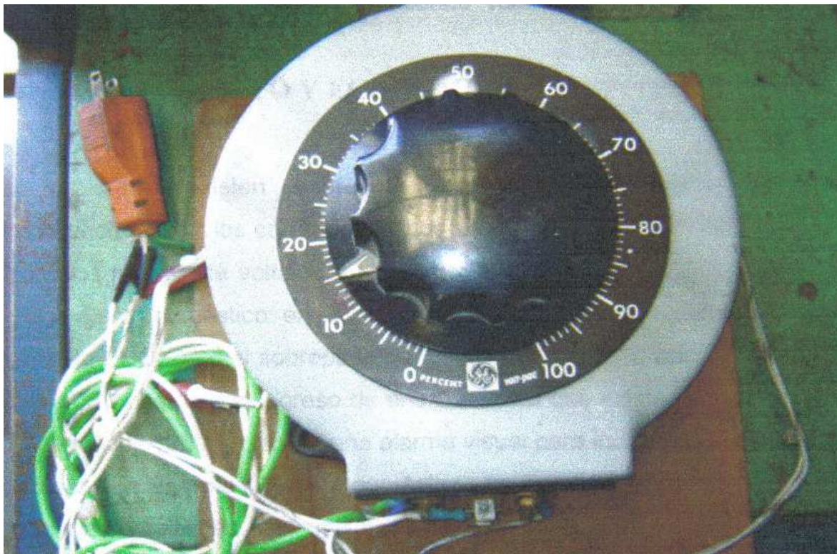
Fotografía 4. Instrumento para variar el voltaje (VARIAC).
