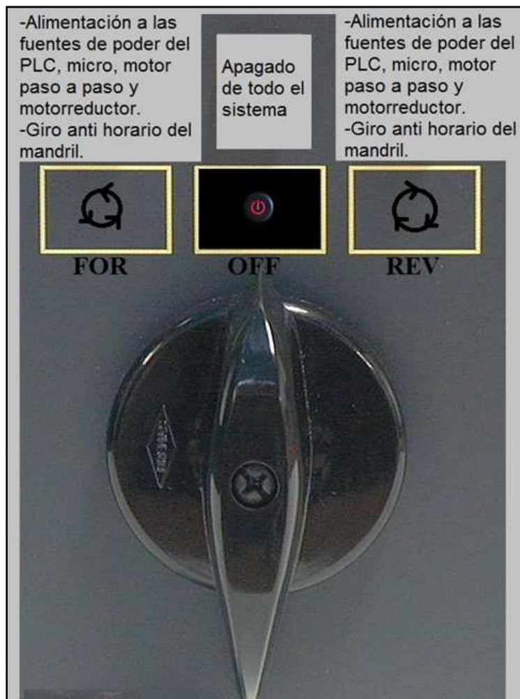
Figura 3-16. Esquema de un selector con similares características al que se usa en el torno
