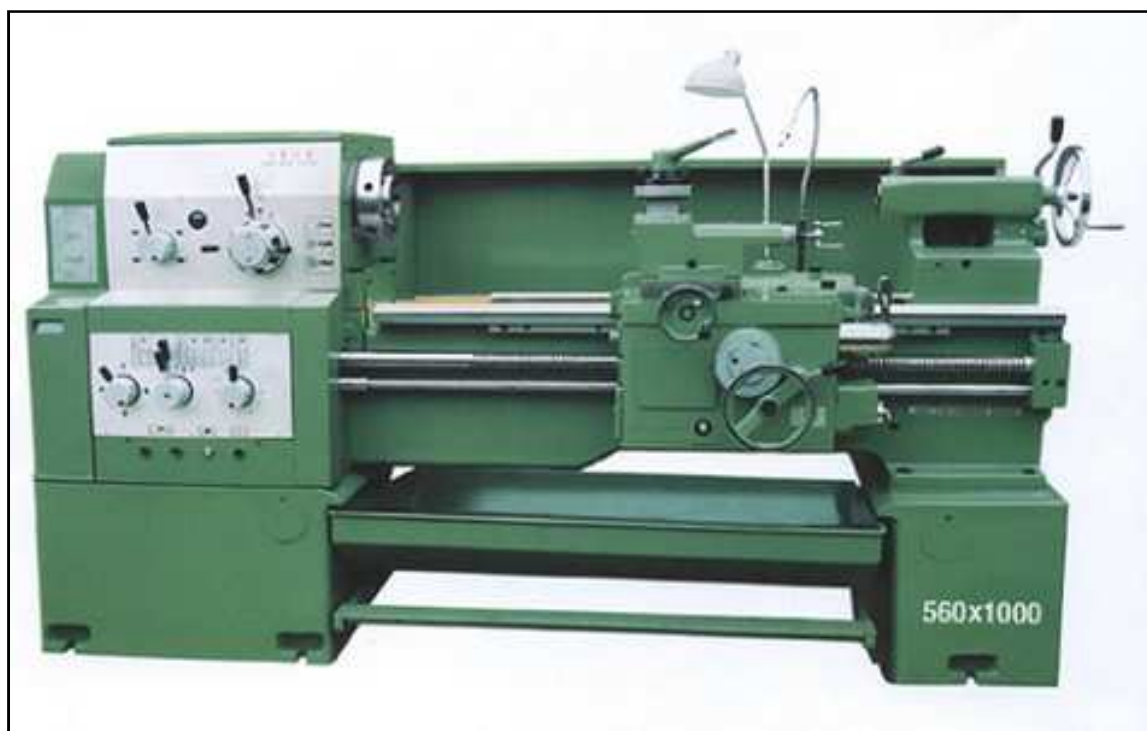
Figura 1-1. Esquema del Torno paralelo 1
