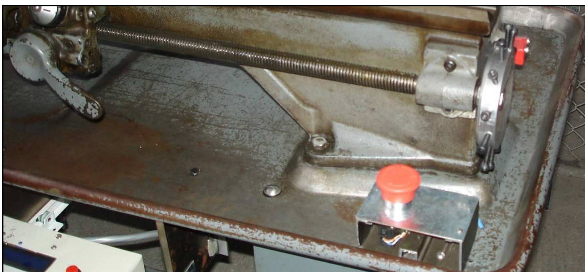
Figura 3-14. Paro de emergencia
