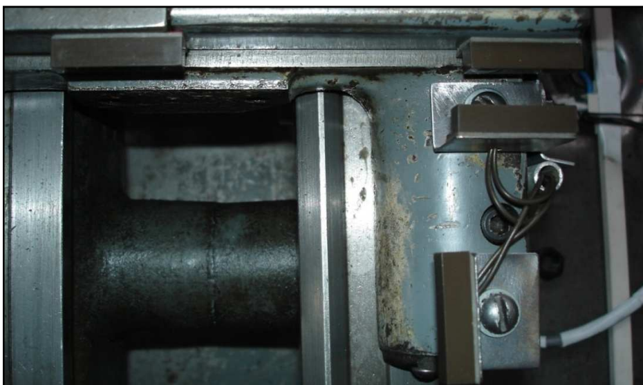
Figura 3-13. Ubicación de los sensores magnéticos utilizados como fines de carrera para el carro transversal
