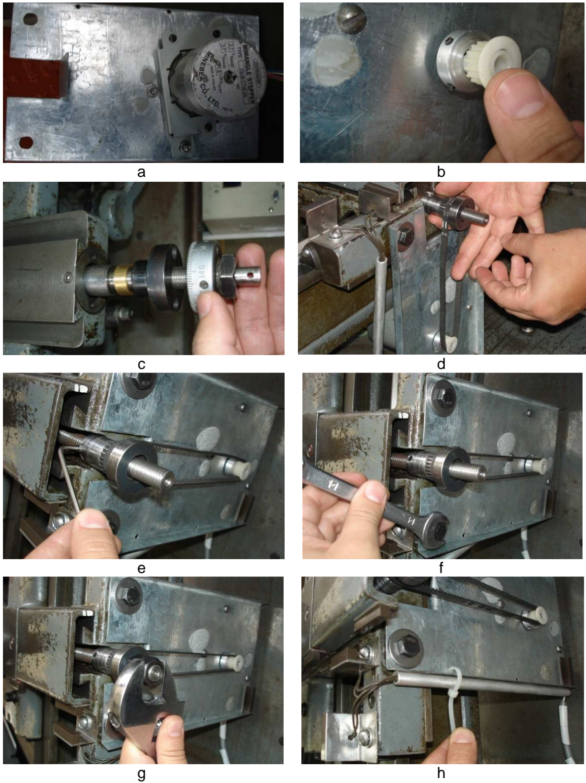
Figura 3-7. Montaje de las piezas utilizados para acoplar el motor paso a paso con el husillo transversal
