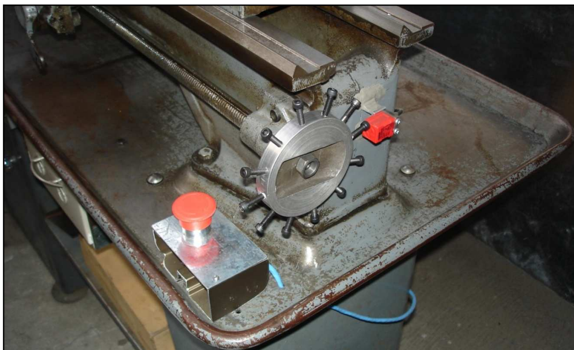
Figura 3-9. Ubicación del sensor inductivo
