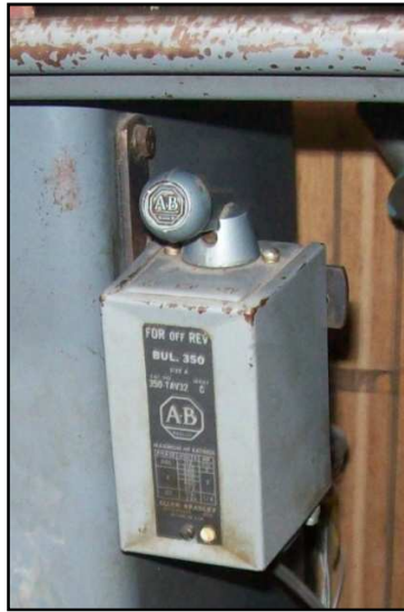
Figura 2-18. Interruptor para encendido del motor del torno
