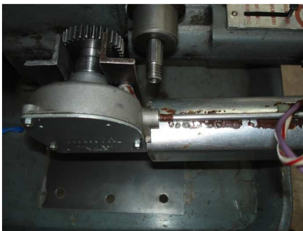
Figura 3-3. Montaje de los elementos que acoplan el motorreductor con el husillo longitudinal.
