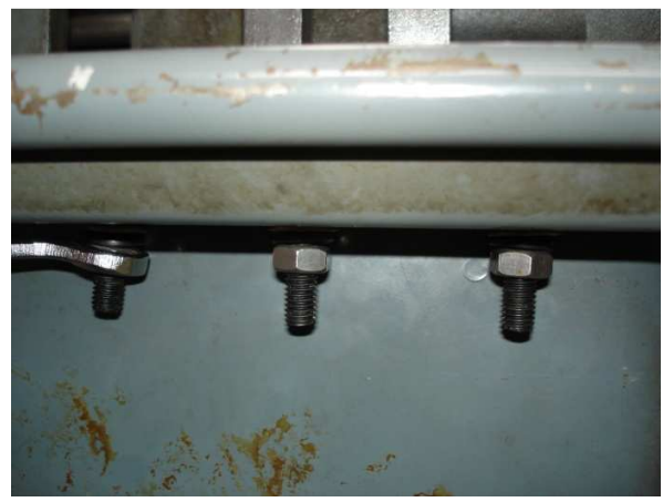
Figura 3-3. Montaje de los elementos que acoplan el motorreductor con el husillo longitudinal.
