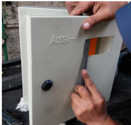
Figura 75. Modificación de gabinete metálico (Burbano, Oña)
