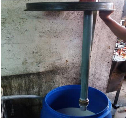
Figura 68. Tubería y válvula de pie (Burbano, Oña)
