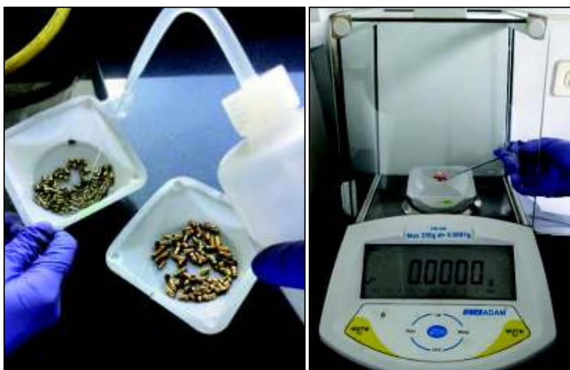
FIGURA 3.10 LIMPIEZA DE VIRUTAS Y PESAJE
