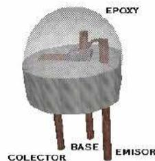
*Figura 1.8. Esquema del fototransistor*
