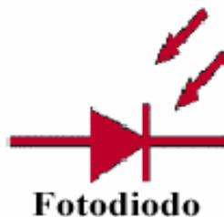
*Figura 1.5. Representación del fotodiodo.*
