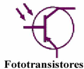
*Figura 1.6. El fototransistor*
