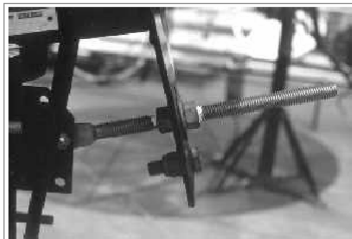
Marcas en el tornillo de elevación FIGURA 2.22
