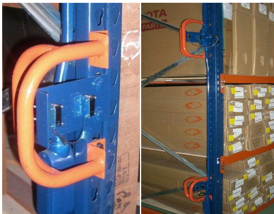
Figura 2.13. Protección de los sensores
