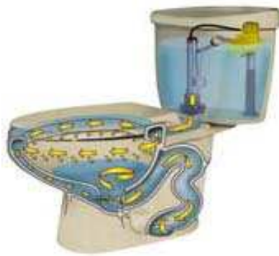
Figura 1.1. Funcionamiento del drenaje
