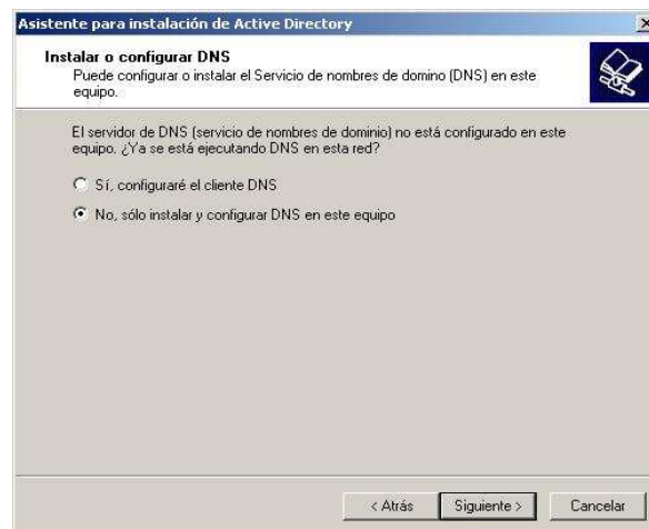
Figura 4.12. Instalación del servicio DNS.
