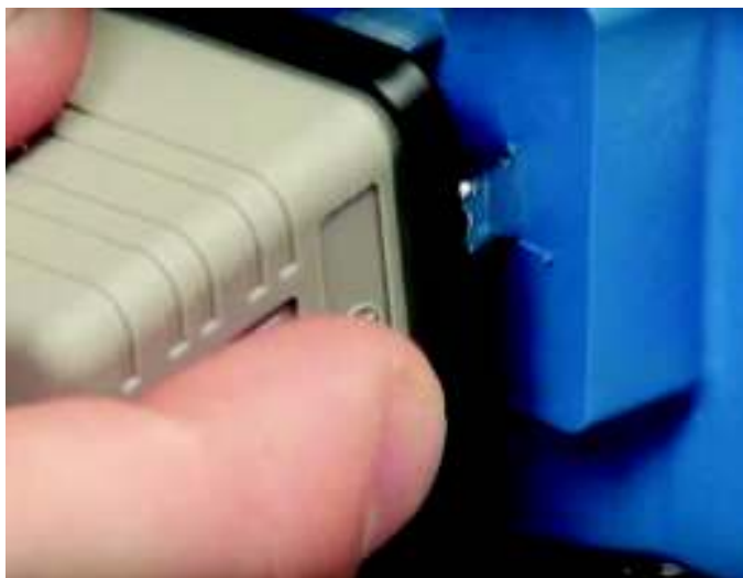
Ilustración 85 Reconexión del transformador
