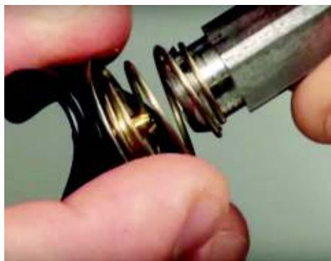
Ilustración 77 Extracción de elementos internos de la electroválvula
