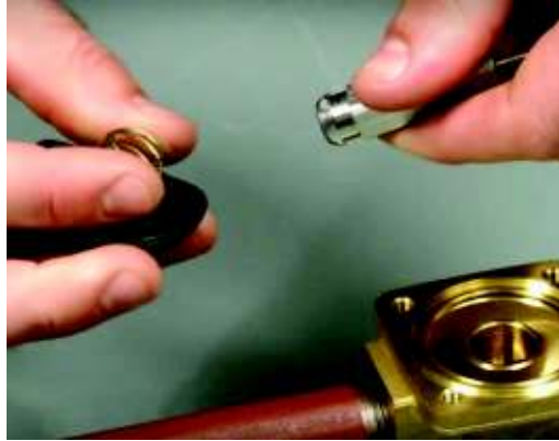
Ilustración 78 Extracción del núcleo
