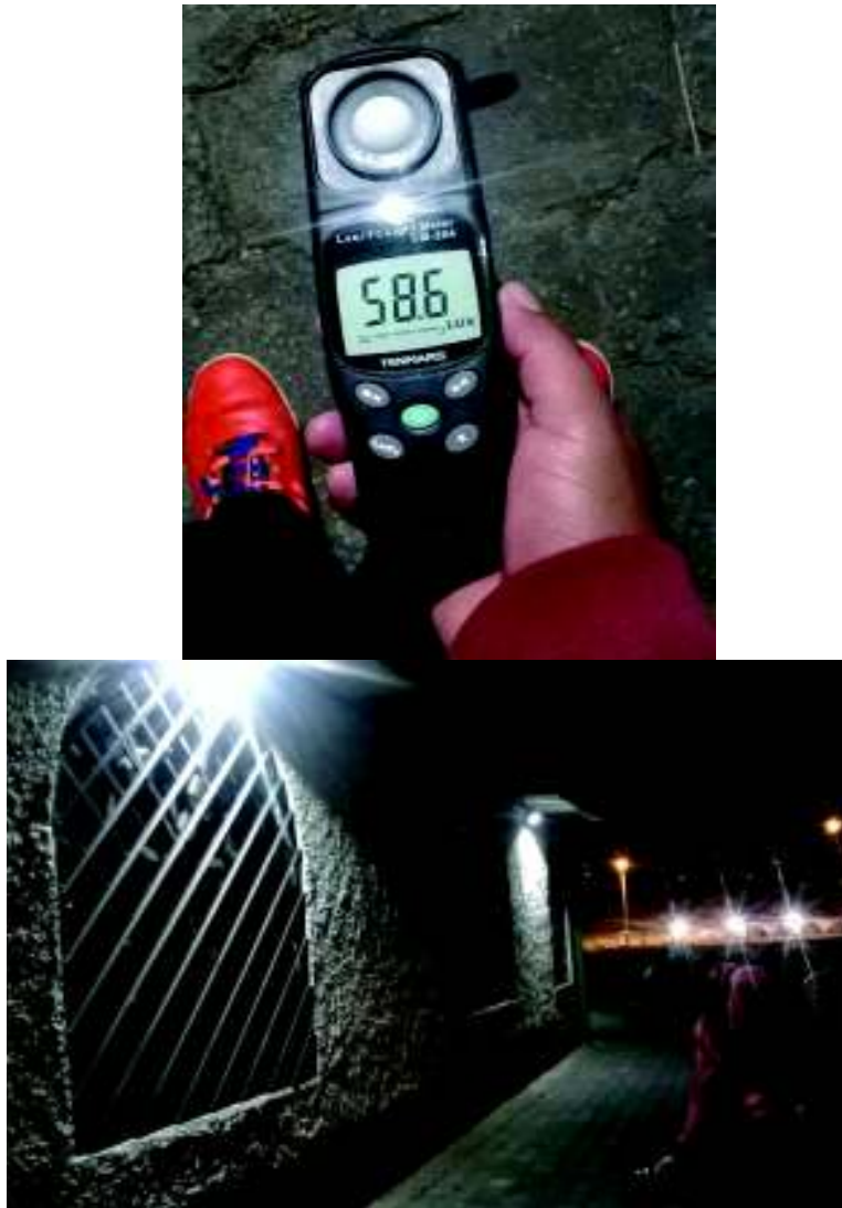
Figura 3.32. Medición del nivel de iluminación área del centro de información Fuente: Propia
