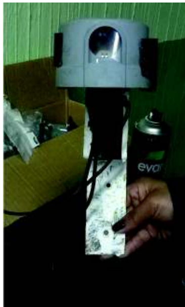
Figura 2.4. Fotocelda del sistema antiguo Fuente: Propia
