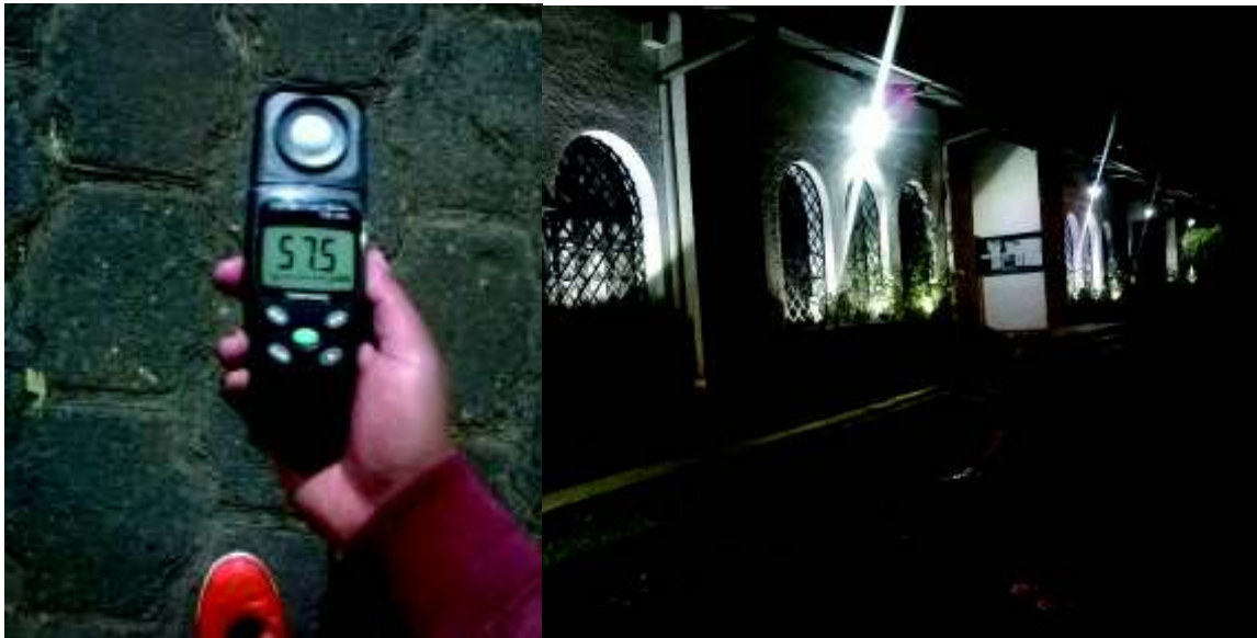
Figura 3.29. Medición del nivel de iluminación parte frontal Fuente: Propia
