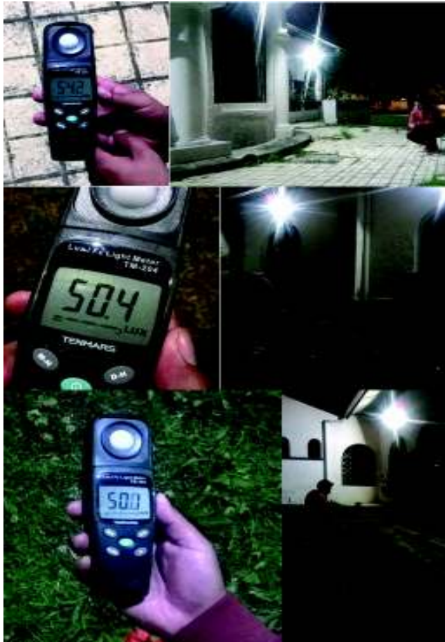
Figura 3.30. Medición del nivel de iluminación parte posterior Fuente: Propia
