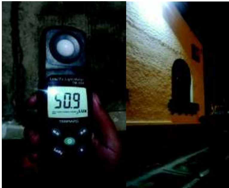
Figura 3.31. Medición del nivel de iluminación área de parqueaderos Fuente: Propia
