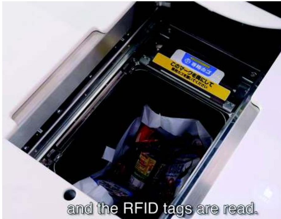
**Figura 2.5.** Mecanismo de empacado del sistema Regi-Robo [15]
