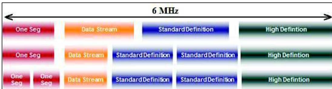
Figura 1.2 Alternativas de uso de canales de televisión en un canal de 6 MHz
