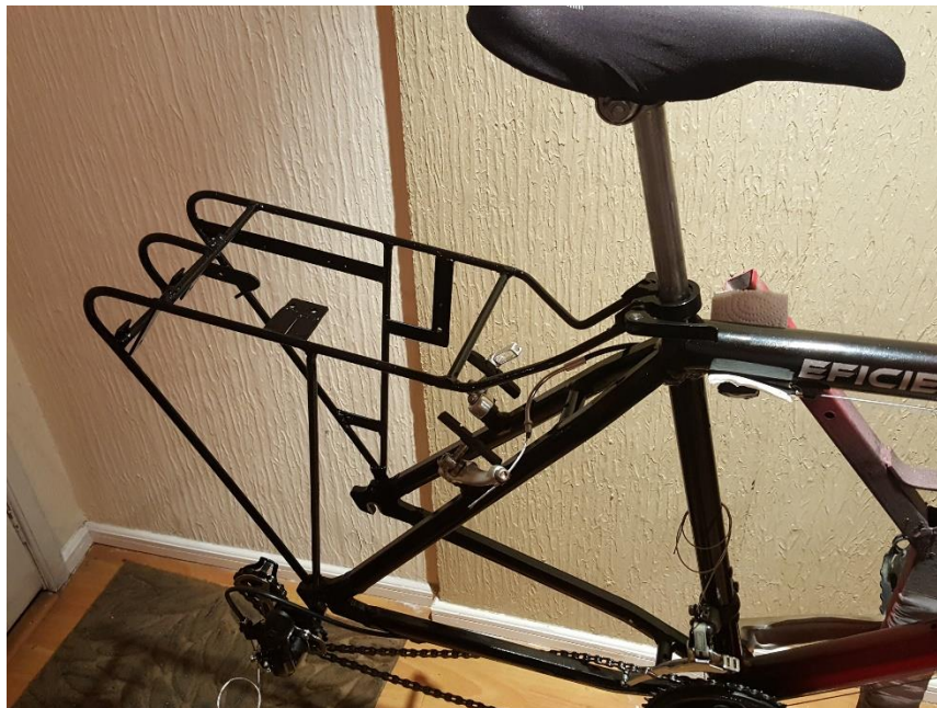
Figura 2.48. Ensamblaje del soporte. (Fuente: Propia)
