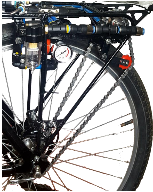
Figura 2.51. Instalación de la cadena. (Fuente: Propia)
