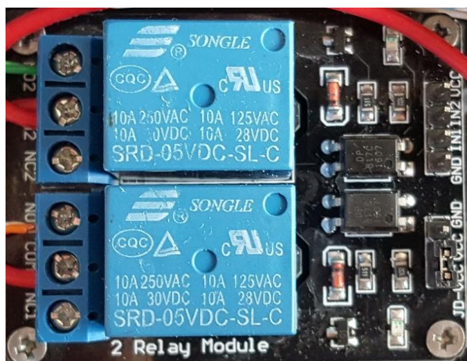
Figura 2.69. Módulo de dos relay.
