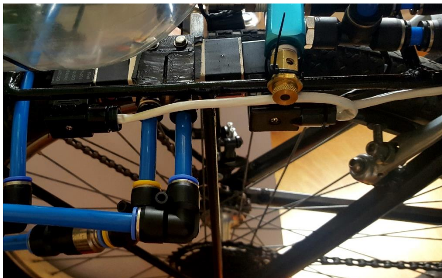
Figura 2.53. Electroválvula montada en el soporte.
