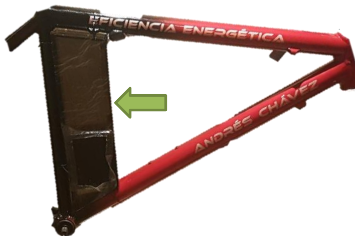
Figura 2.71. Ubicación del sistema de control.
