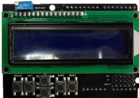
Figura 2.66. Pantalla LCD 16x2.
