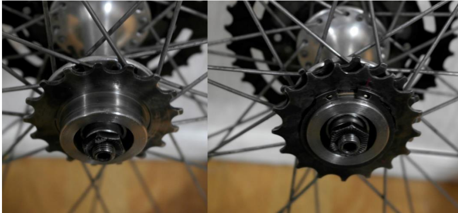
Figura 2.49. Ensamblaje del acople de la rueda posterior. (Fuente: Propia)
