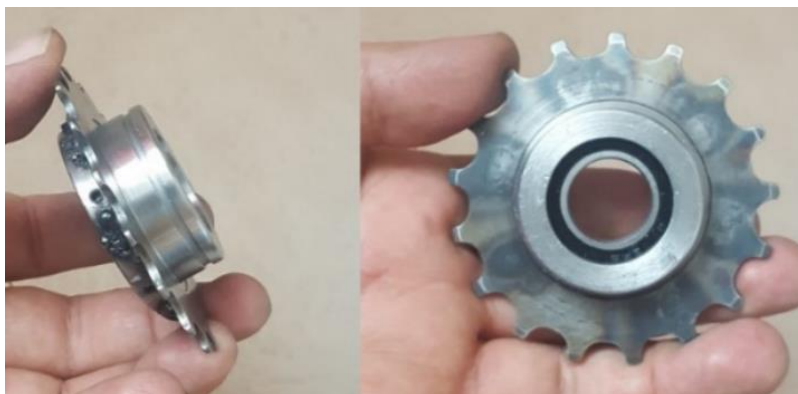
Figura 2.46. Acoplamiento rueda posterior.
