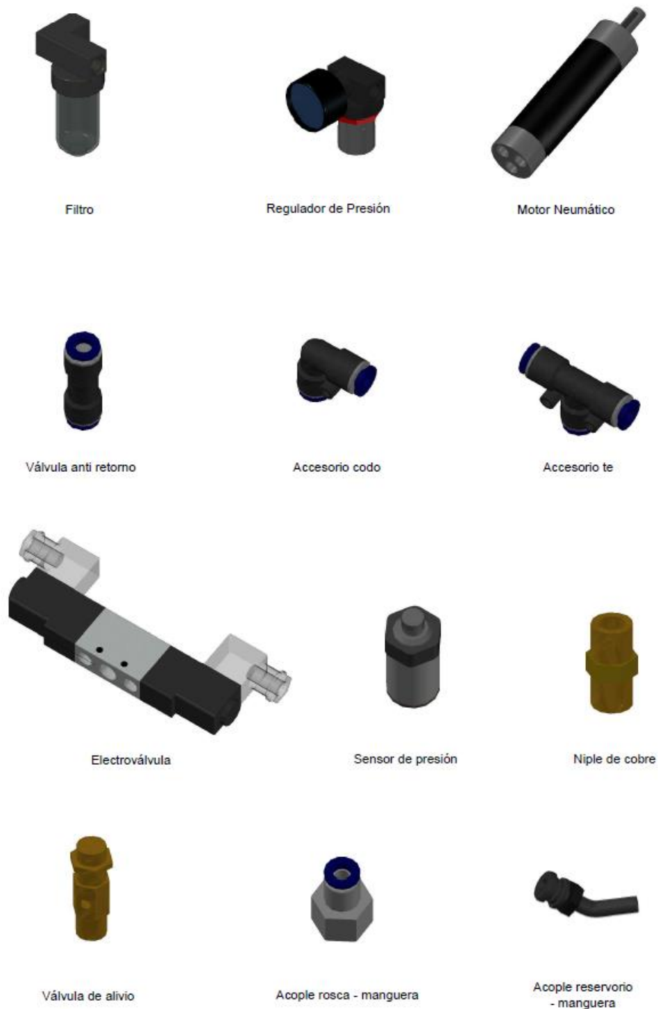
Figura 2.40. Componentes neumáticos modelados en 3D.
