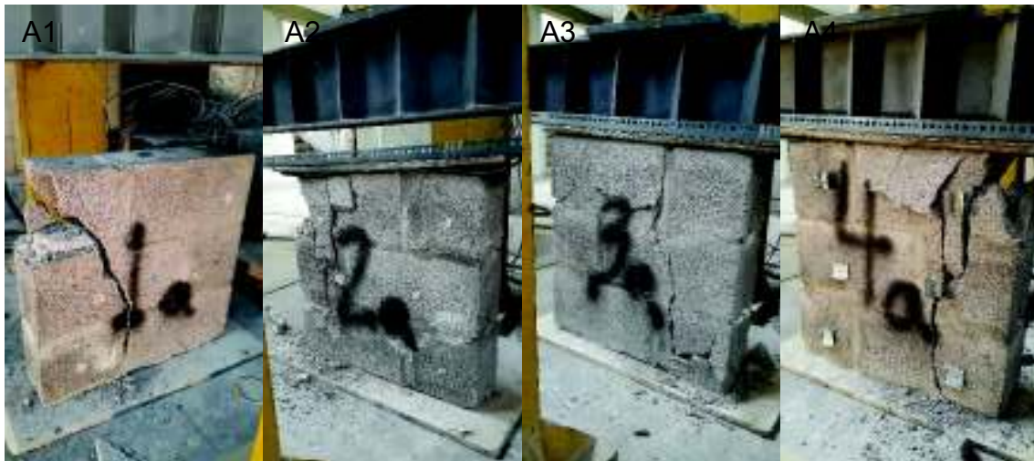
FIGURA 4.17: Fallas típicas de los muretes tipo A:
