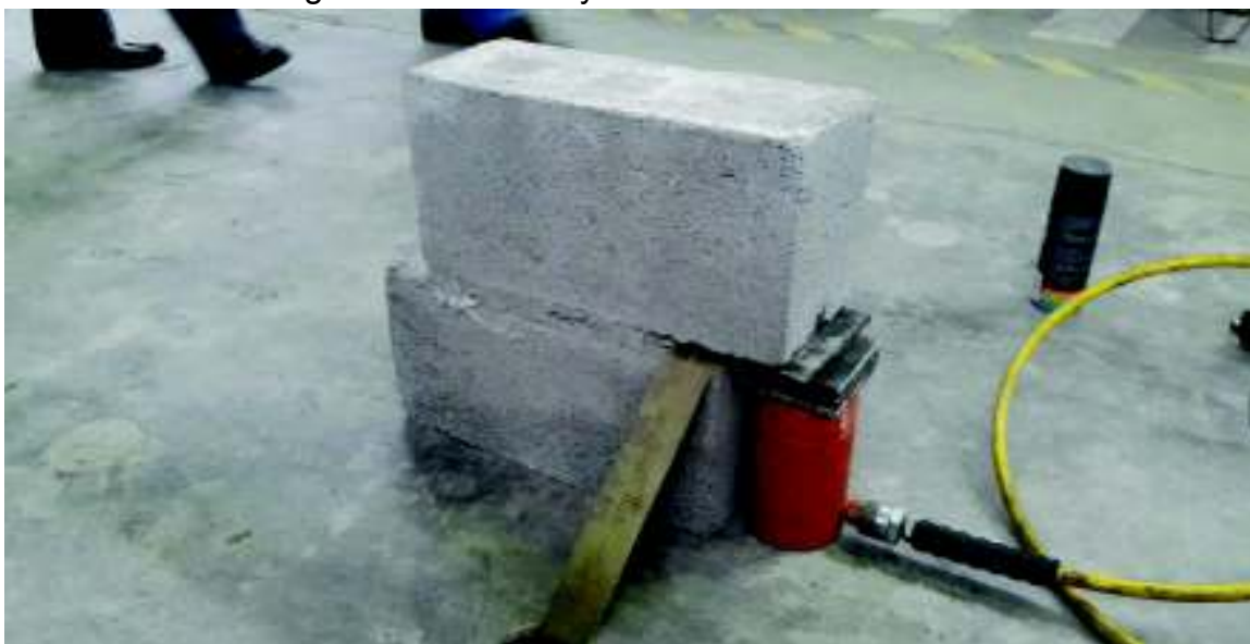
FIGURA 4.39: Configuración del ensayo de adhesión modificado:
